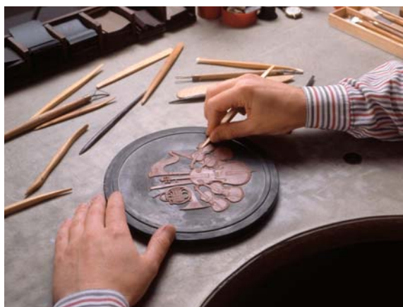
Bild oben: Übertragen der Zeichnung auf das Plastilin Bild unten: Modellieren der groben Form
