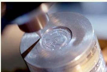
Detailansicht einer Reduziermaschine
