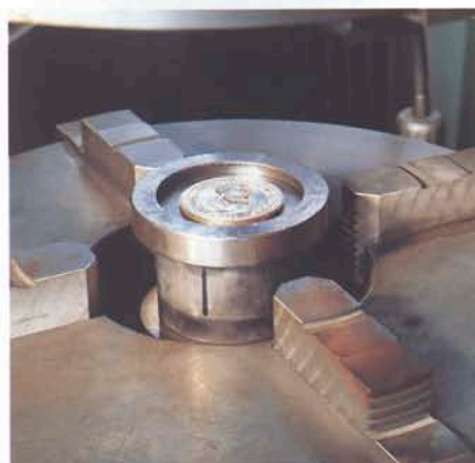
Prägung einer Medaille in Silber auf einer hydraulischen Prägepresse mit ca. 400 Tonnen Druck
