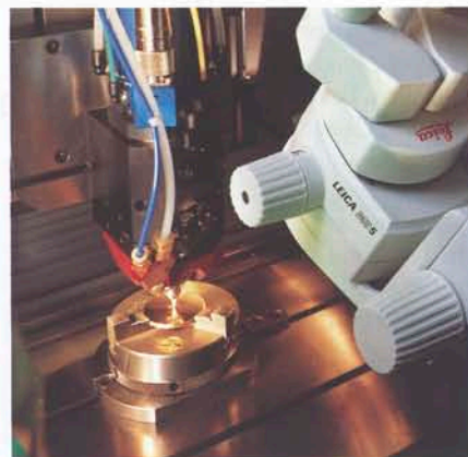
Dreidimensionale Relieffräsung auf einer CNC-gesteuerten Gravurmaschine
