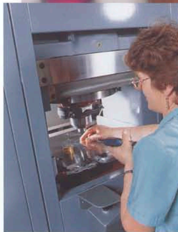
oben: Polieren des Prägestempels links: Manuelles Einlegen der Ronde rechts: Visuelle Kontrolle der geprägten Münze
