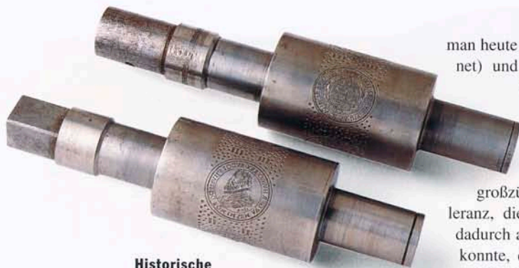
Historische Prägwerkzeuge: Stempel für Walzenprägung (oben), und Stempel für Hammer- und Amboßprägung (rechts), 17. Jh.
