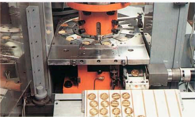
9. Prägung: Es ist soweit. Aus der vorbehandelten Ronde wird der Philharmoniker. Ein einziger Schlag mit der Kraft von ca. 160 t gibt dem Philharmoniker - auf beiden Seiten gleichzeitig - seine unverwechselbare Prägung.
