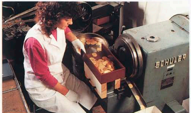
8. Stauchen: Damit die erhabenen Ränder der Philharmoniker, die sogenannten „Stäbchen“, bei der Prägung gut herauskommen, werden die Münzen vor der Prägung gestaucht.
