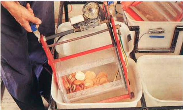
7. Gewichtjustierung: Rondens mit Untergewicht werden eingeschmolzen. Übergewicht wird elektrolytisch, teilweise aber auch durch Fräsen, abgetragen. Bis zu drei Arbeitsgänge können notwendig sein, bevor das Gewicht wirklich stimmt.
