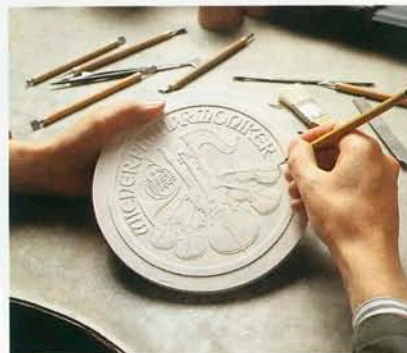
6. Gips-Positiv-Modell: Ein neuerlicher Umguß ermöglicht weitere Überarbeitungen. Im Stadium der Gipsform entstehen durch Änderungen eventuelle Münzvariationen. Beim Philharmoniker war es die 1/4 Unzen-Ausführung (Nennwert öS 500,—).
