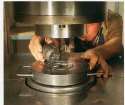
10. Der Einsenkvorgang: Von der nun gehärteten Reduktion wird durch „Einsenken“ in weichen Stahl mit kegelförmiger Oberfläche ein Probestempel hergestellt.
