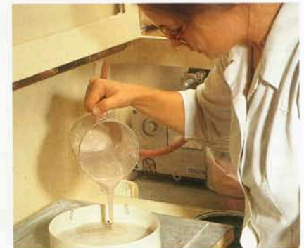
7. Das Kautschuk-Negativ: Da Gips kein sehr widerstandsfähiges Material ist, wird das Philharmoniker-Motiv nun in Silikon-Kautschuk umgegossen - als Vorstufe für ein Kunstharz-Arbeitsmodell.
