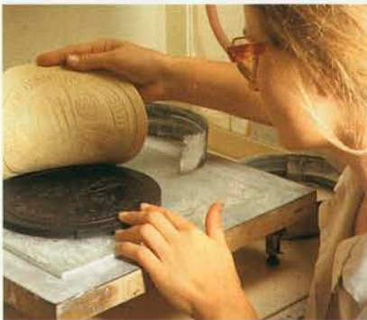
8. Das Kunstharz-Modell: In die Kautschuk-Negativform kommt flüssiges Epoxi-Harz, das durch Aushärtung im Trockenofen zu einer „harten Tatsache“ für die folgende Abtastung auf der Reduziermaschine wird.
