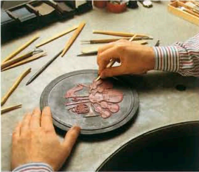
3. Erste Positiv-Vorlage: Um bestmögliche Plastizität bemüht, modelliert Graveur Thomas Pesendorfer das Erhabene der höchstens 1,5 mm hohen Schicht.
