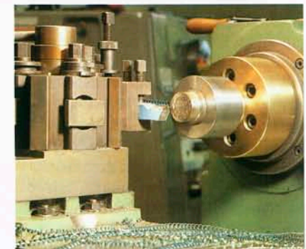
12. Drehen des Stempelhalses: Nun wird dem Stempel ein Hals „angedreht“, damit er in die Prägemaschine eingespannt werden kann. Nach der Härtung des Materials steht einer ersten Probprägung nichts mehr im Wege.
