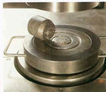
11. Der Probestempel: Dieser negative Stempel zeigt in weiterer Folge bei der Probprägung, ob sich Vor- und Rückseite des Philharmonikers „vertragen“. Denn die verschiedenen Motive von Münzen bedingen ein unterschiedliches Fließverhalten des Münzen-Materials beim Prägevorgang.
