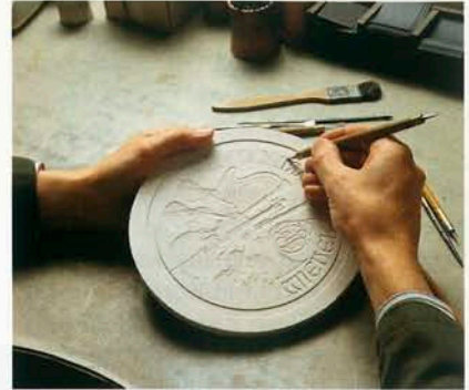
5. Gips-Negativ-Modell: Jetzt werden verschiedene Details - vor allem die Schriften - in das Gips-Modell eingeschnitten.
