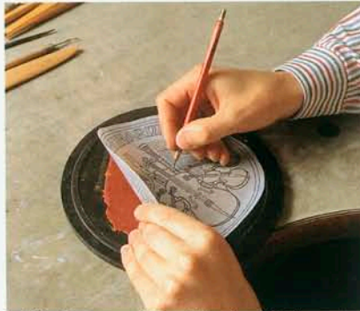
1. Die Pause auf Plastilin: Der Zeichenentwurf für den Philharmoniker* wird mit einer Reißnadel auf eine Auflage aus Spezialplastilin übertragen.
