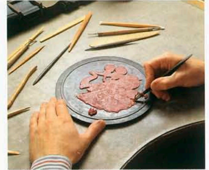
2. Schaben des Plastilins: Alles, was auf der Münze erhaben sein soll, bleibt stehen. Was das Planum (die Grundfläche) bildet, wird weggenommen.
