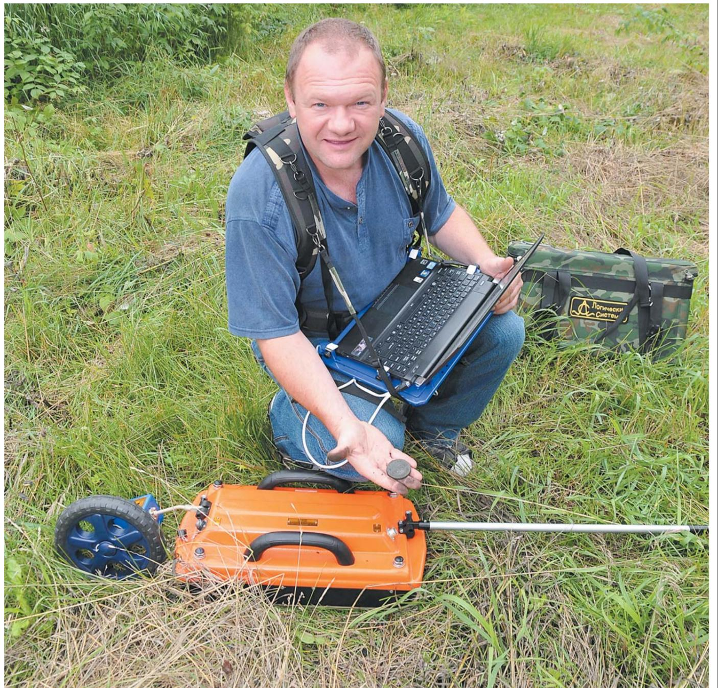
Высокочастотные модели георадара способны, по словам их разработчиков, видеть отдельную крупную монету на глубине до двух метров
