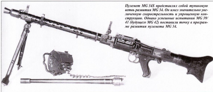
Пулемет MG 34/41 и MG 34S имели укороченный ствол (50 см) и скорострельность 1200 и 1500 выстр./мин, соответственно.
