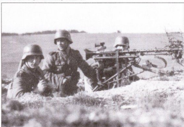
Пулемет MG 34 мог вести прицельный огонь на значительное расстояние благодаря станку и оптическому прицелу MG Z.
