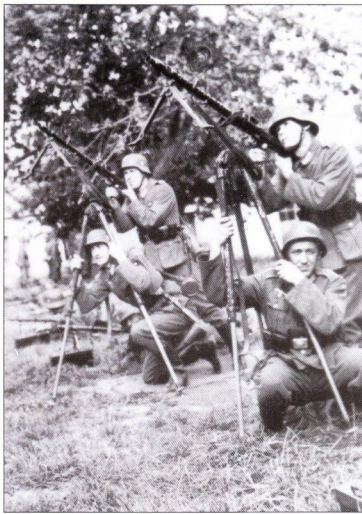
Пулеметы MG 34 на зенитных станках Dreibein 34. Обратите внимание на крупные кольцевые прицелы (Kreiskorn). Вторые номера расчетов повисли на станках, чтобы придать им дополнительную устойчивость.
