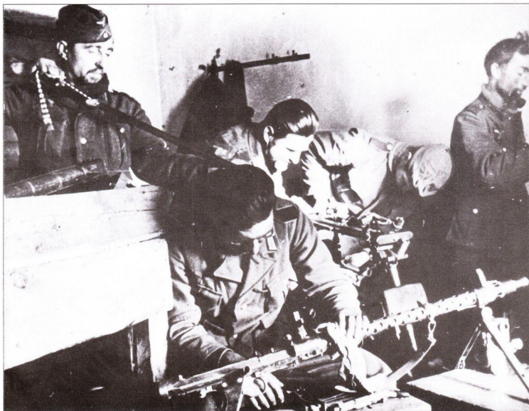
Пулемет MG 34 клинил даже при небольших застряниях, поэтому солдатам приходилось чистить его при любой возможности. На снимке солдат на переднем плане чистит пулемет, а его двое товарищей занимаются станком. Солдат слева чистит сменный ствол с помощью гибкой цепочки. Перед ним лежит контейнер для ствола. Пятый солдат (справа) занят приготовлением завтрака.
