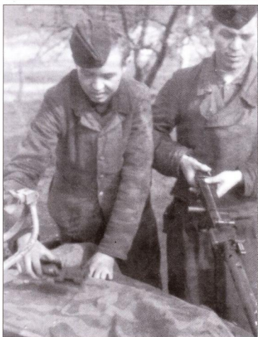
Танкист войск СС разбирает танковый пулемет MG 34. Обратите внимание на пламегаситель и приклад на переднем плане, детали башенного зенитного станка. Из-за бронированного кожуха ствола танковая модификация пулемета MG 34 весила более 12 кг.
