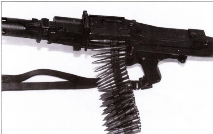
Патронная лента вставлена в патронник (Zufuehrer) пулемета MG 34.
