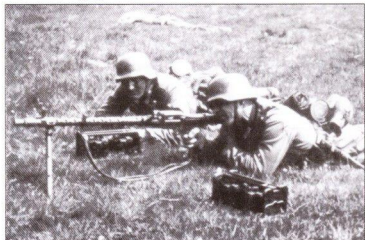
Пулемет MG 34 в варианте ручного пулемета. Обратите внимание на две перепоски для 50-зарядных барабанов и плечевой ремень.
