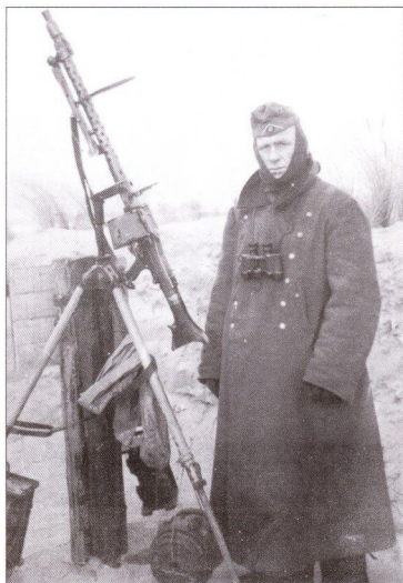
Пулемет MG 34, трехногий станок прижат к вкопанному в землю столбу. Обратите внимание на импровизированные грузы, подвешенные к ногам станка, чтобы повысить его устойчивость. В качестве одного из грузов используется переноска для пары барабанных магазинов.
