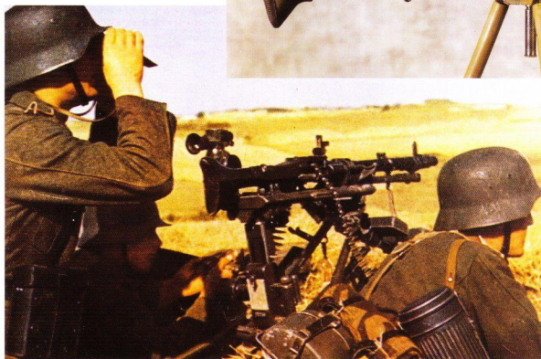
Пулемет MG 34 с 75-мм двойным седельным барабанным магазином на зенитном станке Lafette 34. Под затвором виден механизм горизонтальной и вертикальной наводки, который позволял вести прицельный огонь по точечным целям. Спуск осуществлялся гашеткой, расположенной справа.
