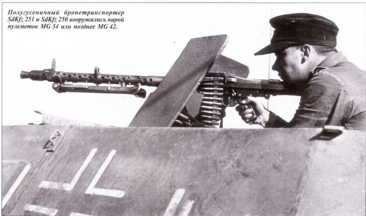
Усилитель отката-пламегаситель (Rueckstossverstaerker) стабилизировал работу механики затвора (основанную на принципе короткого хода ствола), одновременно уменьшал дульную вспышку и служил для крепления сошки.
