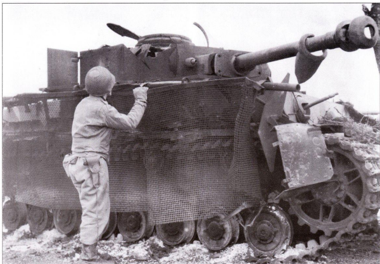
Пулеметы MG 34 предназначались для защиты танка в ближнем бою. Один пулемет устанавливался в лобовой броне в шаровой установке. Другой, спаренный с пушкой, находился в маске пушки. На снимке Pz-Kpfw IV Ausf. J. Борта прикрыты сеткой для защиты от кумулятивных снарядов.
