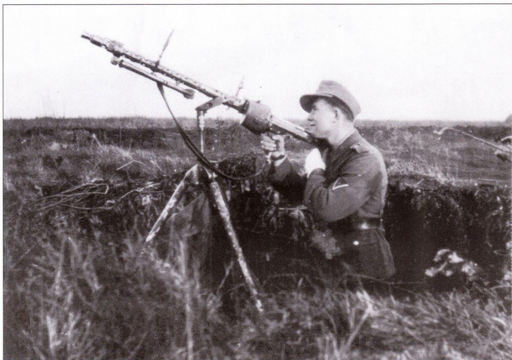
Пулемет MG 34 на трехногм зенитном станке Dreifüß 34. Обратите внимание на 50-зарядный барабанный магазин. При высоких углах возвышения стрелять из пулемета, используя простую ленту, было тяжело, поскольку ленту часто перекашивало.
