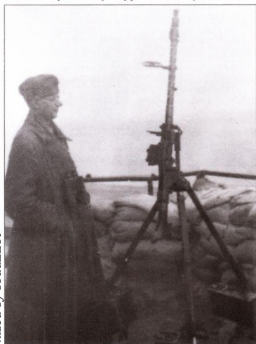
Пулемет MG 34 на зенитном станке, побережье Ла-Манша.. Обратите внимание на патронные ящики, прикрепленные к стойкам, для придания всей конструкции дополнительной устойчивости.
