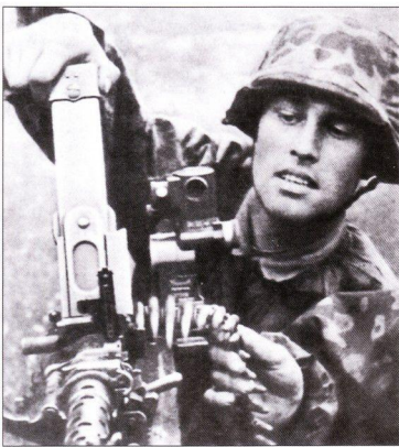
Заряжание пулемета MG 34 250-зарядной лентой из патронного ящика (Patronenkasten 41).
