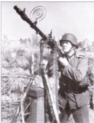
Прекрасный вид на пулемет MG 34 на зенитном трехножном станке. Хорошо видны детали кольцевого прицела (Kreiskorn). Деревянный столб, врытый в землю, обеспечивает устойчивость станку.
