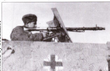
Пулемет MG 34, установленный на крыше штурмового орудия Sturmgeschuetz III. Штурмовые орудия не имели вращающейся башни, поэтому для ближней обороны применялись открыто расположенные пулеметы.
