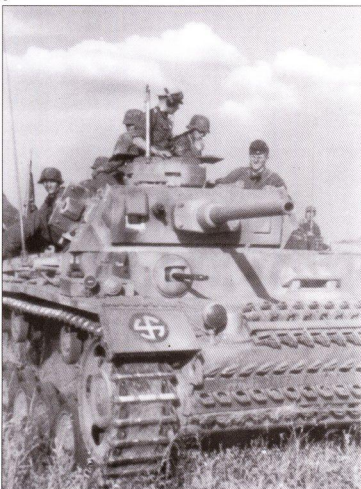
Танк PzKpfw III Ausf. L из танковой дивизии SS Wiking, лето 1943 г. Обратите внимание на пулемет MG 34 в шаровой установке. Еще один пулемет спарен с пушкой. Боекомплект танка включал порядка 5000 патронов к пулеметам.
