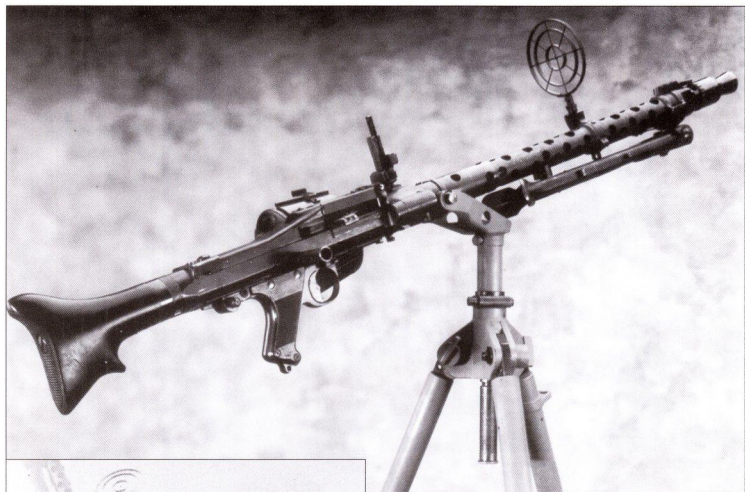
Пулемет MG 34 с 50-зарядным барабанным магазином на зенитном трехногом станке.
