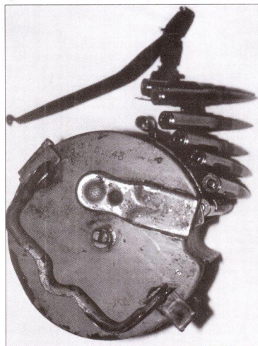
Два фото: барабанный магазин Gurttrommel 34, внутри которого помещалась 50-зарядная лента.
