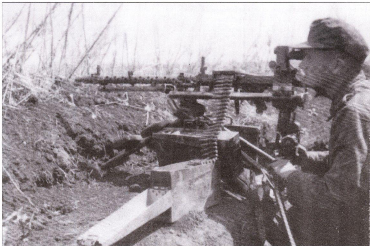
Пулемет MG 34 на станке Lafette 34 с оптическим прицелом MG Z. Вокруг стоит несколько ящиков с патронами.
