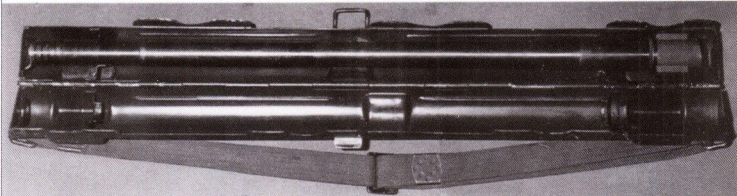
Коробка для запасного ствола в открытом положении. Виден вложенный в нее пулеметный ствол.
