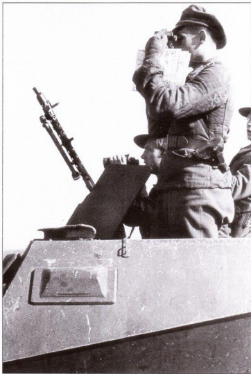
Передний пулемет полуусищенного бронетранспортера прикрывал легкий бронещиток.
