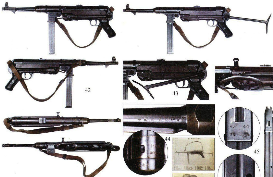
42. Различные виды MP 40 со сложеным и развернутым прикладом. 43. Детали складного приклада. 44. Метка изготовителя, дата изготовления, серийный номер и клеймо Waffenamt. 45. 32-зарядный магазин с правильными метками. Обратите внимание на цифру «32», указывающую на емкость. 46. Две страницы из руководства пользователя MP 40.
