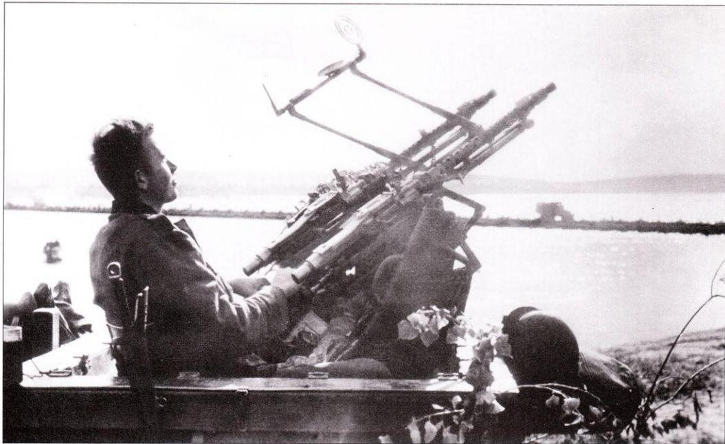
Пулеметная повозка (tachanka) If.15, такие повозки состояли на вооружении пулеметных рот батальонов, по три тачанки в звиде, шесть пулеметов. Была предусмотрена возможность демонтажа пулеметной установки с повозки и рассоединения спаренных пулеметов на одиночные. Скорострельность спаренной пулеметной установки пулеметов MG34 составляла 1600 - 1800 выстрелов в минуту.
