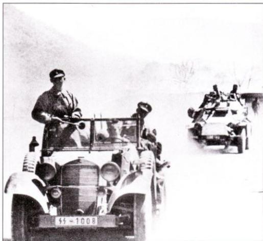
Автомобиль Kfz. 15 массово использовался в войсках СС. За Kfz. 15 следует бронеавтомобиль Sd.Kfz. 222, вооруженный автоматической пушкой и пулеметом.
