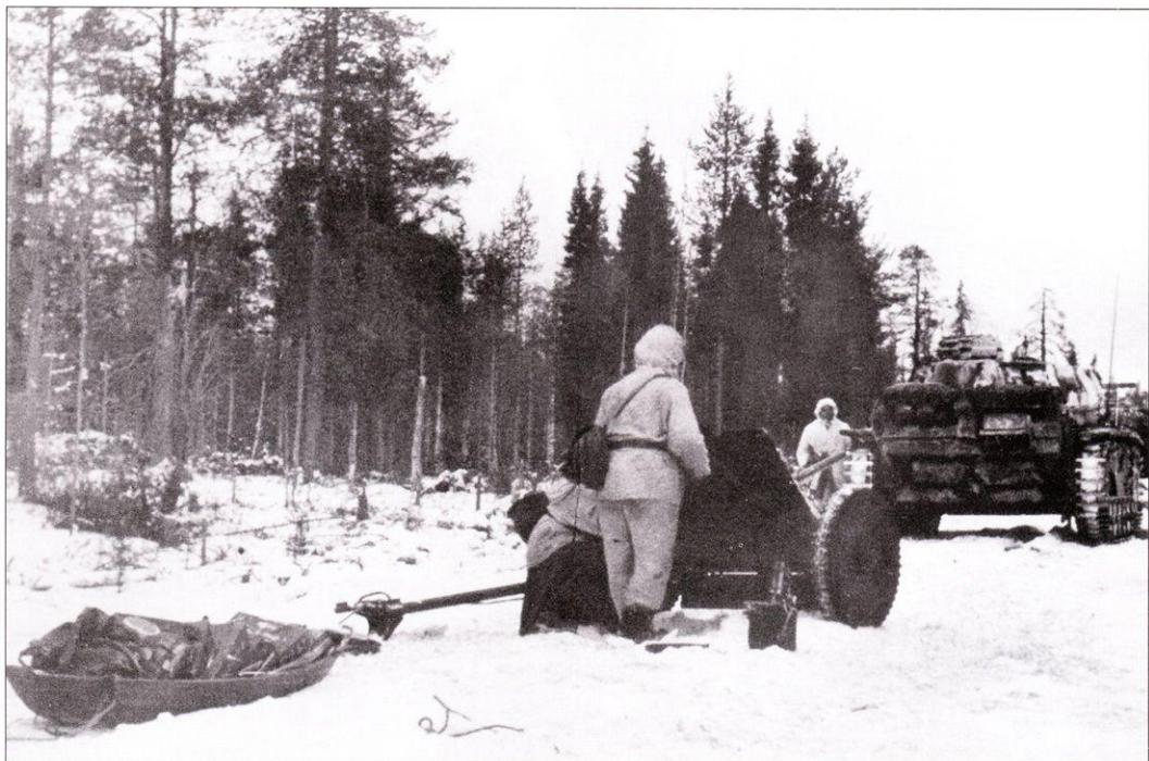
*Подразделение дивизии «Норд» в лесу. Для войны в лесистой местности пришлось отработать специальную тактику, придумать новые технические средства. На переднем плане - противотанковая пушка РаК-36 калибра 37 мм, на заднем плане - танк Рз. Крфв. III. Пушки калибра 37 мм годились для разрушения полевых укреплений, но никак не для борьбы с советскими танками. Снаряды к пушке складывались в небольших лодкообразных санях «Ахкю». Снимок сделан в Финляндии.*
