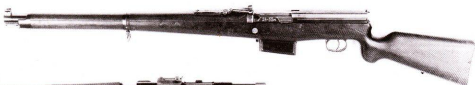
Пистолет-пулемет Фольмера образца 1935 г., III вариант. Оружие разработано под патрон 7,75x39,6 мм - первое оружие под промежуточный патрон. По ряду причин пистолет-пулемет в серийное производство запущен не был.
