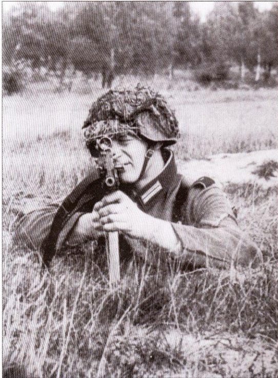
Вид спереди бойца, вооруженного МР-43/1 с оптическим прицелом ZF-4. На фото хорошо виден существенный недостаток МР-43 - длинный магазин, мешающий бойцу вести огонь в положении лежа. Дёбритце, 1943 г.
