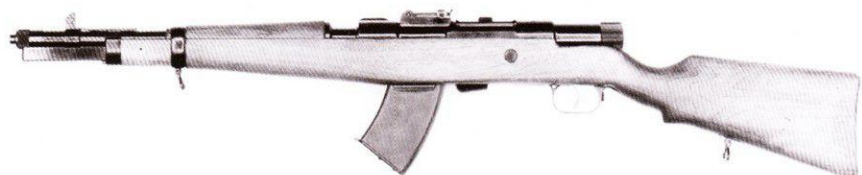
Пистолет-пулемет Фольмера образца 1935 г., III вариант. Оружие разработано под патрон 7,75x39,6 мм - первое оружие под промежуточный патрон. По ряду причин пистолет-пулемет в серийное производство запущен не был.
