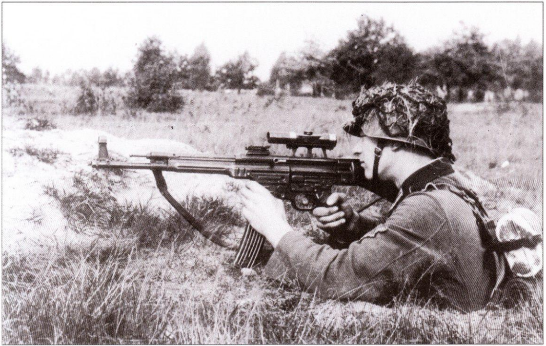
Отличный снимок, сделанный во время испытаний МР-43/1 с оптическим прицелом в Дёбритце, серийный номер машиненкарабинера - 918. Можно сказать, что на фото - гибрид со стволом, имеющим уступ под крепление гранатомета и переданным, как у МР-43, пьедесталом мушки.
