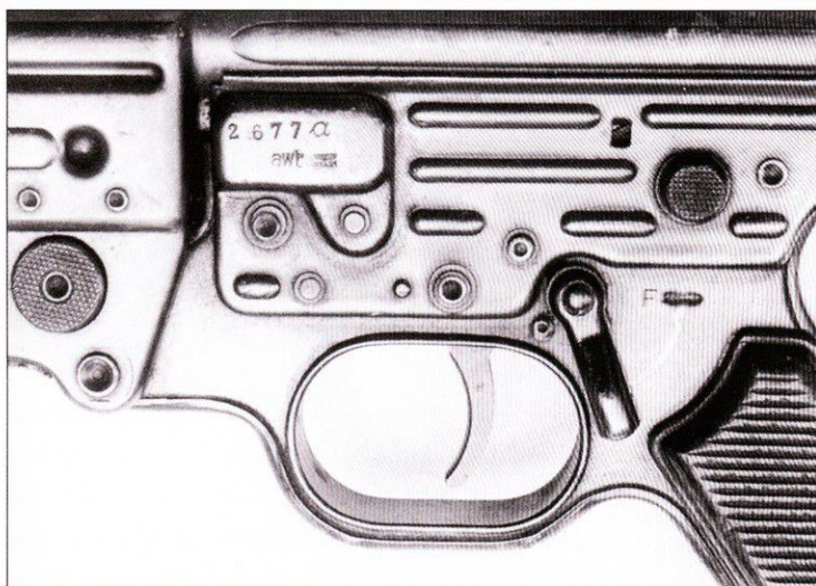
Крупный план органов управления штурмгевера: кнопка отсоединения магазина, спусковая скоба, предохранитель и кнопка переключения режима стрельбы.
