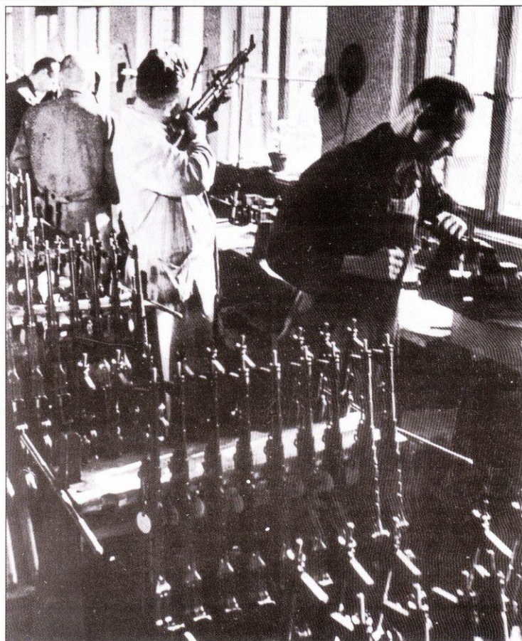
Фото фирмы Маузер - станок для испытания МР. Металлический рукав предназначен для сбора стреляных гильз. Фото датировано ноябрем 1944 г. На других снимках из этой серии видна маркировка оружия - МР-44. Обендорф, 1944 г.
