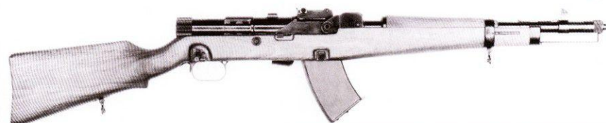
Пистолет-пулемет Фольмера образца 1935 г., III вариант. Оружие разработано под патрон 7,75x39,6 мм - первое оружие под промежуточный патрон. По ряду причин пистолет-пулемет в серийное производство запущен не был.
