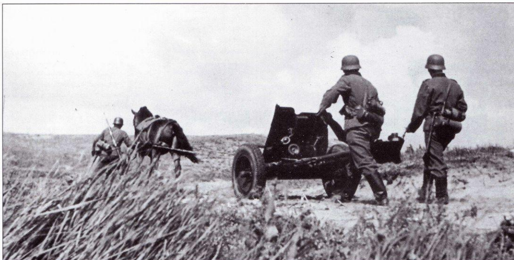
Расчет 37-мм противотанковой пушки PaK-35/36 на марше. Пушку буксирует одна лошадиная сила, которой помогают артиллеристы. Орудие весило совсем немного – 440 кг, поэтому для ее буксировки вполне хватало одного коня.
