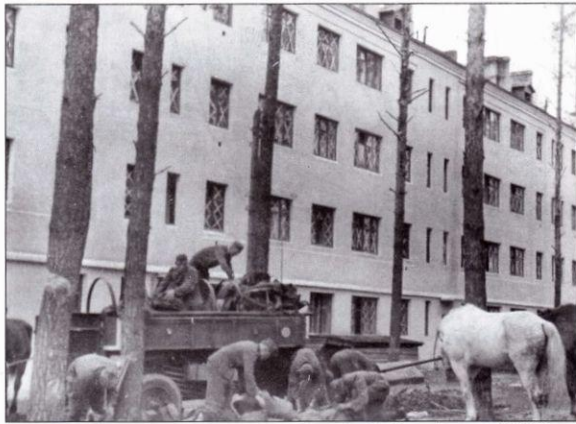
Современнейшие большие конные повозки (große Katrufwagen) Нф.7/11 поступали только на вооружение боевых частей первой линии. Корпус повозки был стальным, колеса снабжены резиновыми шинами. За откидными бортами находились багажники. Обычно в такую повозку запрягали пару лошадей. Грузоподъемность повозки составляла 1,5 т. Повозки очень часто камуфлировались, внутри они окрашивались в полевой серый цвет. Обратите внимание на заклеенные крест на крест полосками бумаги стекла оконных проемов здания.
