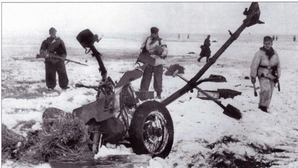
Немецкие солдаты осматривают подбитое советское противотанковое орудие калибра 45 мм. Образца 1937 или 1942 г. (с длинным стволом). Пушка представляла собой развитие лицензионного варианта германского 37-мм противотанкового орудия PaK-36/37. В СССР эти пушки известны как 37-мм противотанковые орудия образца 1930 и 1932 г.г. На лафет германского орудия советские конструкторы наложили ствол калибра 45 мм, а боекомплект дополнили фугасным снарядом. В результате получилось довольно удачная многофункциональная пушка. В 1941-1942 г.г. германские войска захватили в исправном состоянии приличное количество советских «сорokaпюток» и использовали их под обозначением 4.5 cm PaK-184(r) и 4.5 cm PaK-184-1(r).
