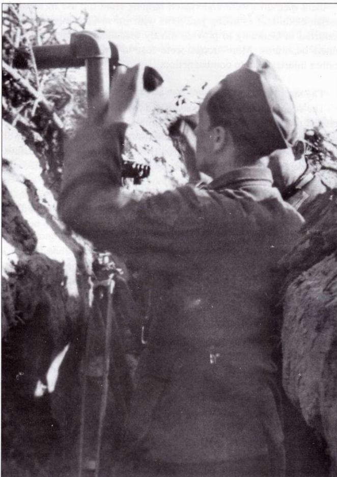
Передовой артиллерийский наблюдатель осматривает местность в стереотрубу 6x30 Sf.14Z Scherenfertrohr. В каждой артиллерийской батарее имелись такие корректировщики-наблюдатели. Корректировочные посты располагались в боевых порядках пехоты, связь поста с батареей обычно осуществлялась с помощью линии полевого телефона.
