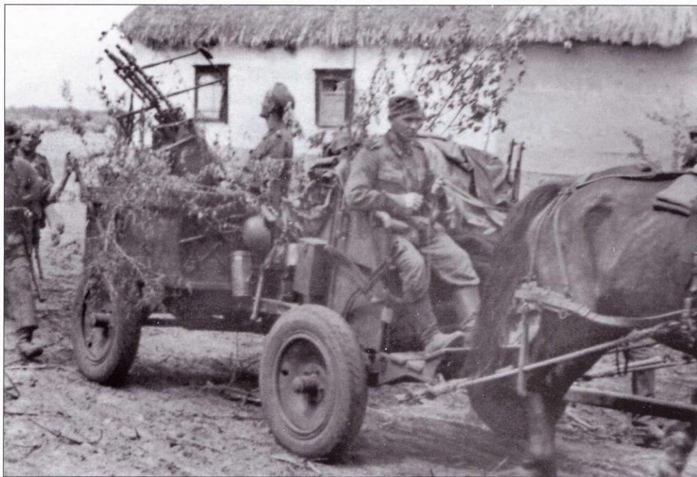
*Одноосная спаренная пулеметная установка Maschinengewehr-Doppelwagen на конной тяге. При использовании лошади, пулеметная установка буксировалась с использованием передка, к автомобилю - цеплялась напрямую. Данная пулеметная установка получилась очень удачной, но «повозка» пулемета была изготовлена из стали, которой в военные годы в Германии стало не хватать.*
