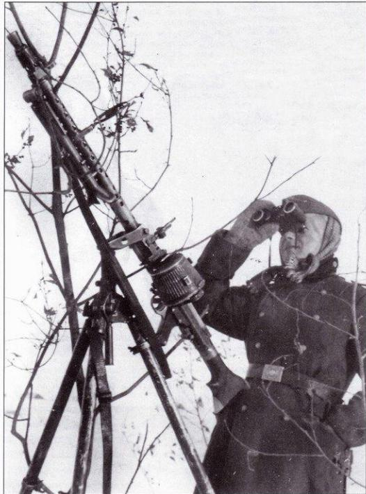
Пулеметчик осматривает воздушное пространство в поисках советских самолетов. Пулемет MG-34 оснащен 50-патронным магазином барабанного типа и зенитным прицелом. Пулемет установлен на зенитной турели Dreifuss-34. Пулеметчик утеплил голову неуставным платком, одев поверх платка форменную пилотку.
