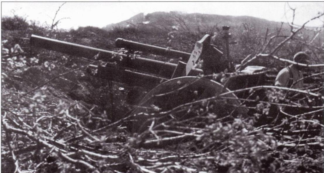
*Порой на вооружении горной артиллерии состояли пехотные артсистемы дивизионного уровня, особенно - если горные стрелки действовали на равнинной местности, что войну случалось постоянно. На снимке - легкая 105-мм левая гаубица 1e.FH18.*
