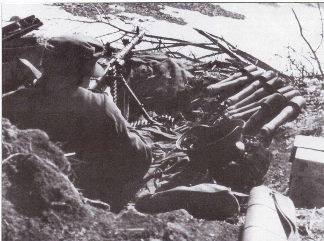
*Пулеметное гнездо, пулемет - MG34. Обычно сошки крепились к стволу в районе мушки, но здесь пулеметчик закрепил сошки в районе лентоприемника. На брусстере лежат гранаты Stg24 и пулеметные ленты. На переднем плане - контейнер с запасными стволами, такие контейнеры вообще-то полагались к станковым, а не к ручным пулеметам MG34.*
