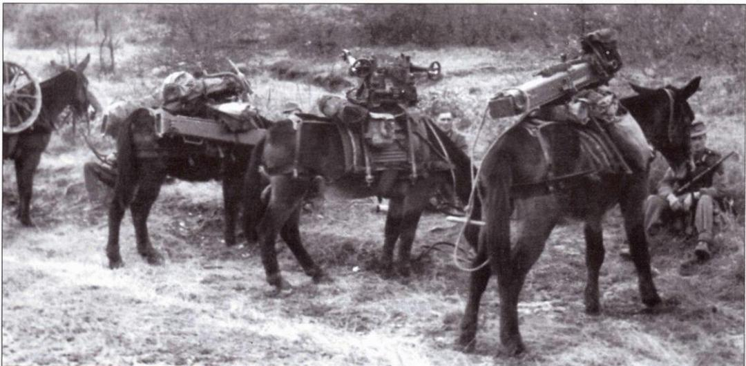
*Мулы с навьюченной на них разобранной 75-мм горной пушкой GebG36. Пушку в разобранном виде перевозило восемь мулов. Сборка орудия занимала десять минут. Орудие выпускалось в варианте с деревянными колесами без пневматиков и в варианте со стальными колесами, снабженными резиновыми шинами.*
