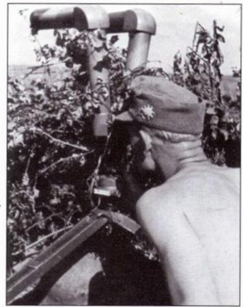
Артиллерийский наблюдатель из подразделения горной артиллерии наблюдает в стереоскопический наблюдательный прибор. На линзы стереотрубы одеты «наглазники», уменьшающие бликование оптики на солнце. Позиция наблюдателя замаскирована. Стереотрубы обычно окрашивались в серый цвет.
