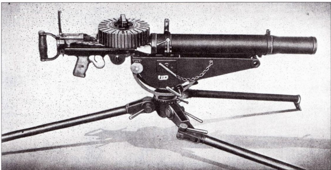
Военно-морской пулемет тип 92, копия Льюиса. Такие пулеметы использовались на кораблях небольшого водоизмещения в качестве зенитных.
