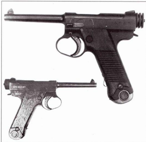
Пистолет Тайхо тип 4 был принят на вооружение в 1925 г. На двух фото приведены оба варианта - с оригинальным небольшим ограждением спускового крючка и увеличенным «маньчжурским» ограждением оно.
