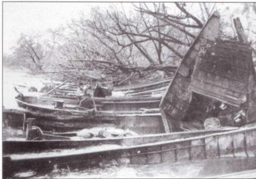
Поврежденные артобстрелом десантные баржи кохацу длиной 9 м. Помимо военно-морского флота, десантные баржи состояли на вооружении некоторых саперных частей японской армии.
