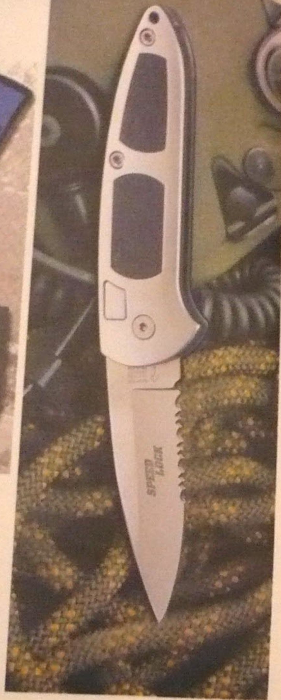
Нож Спидлок ( Speedlock ) фирмы «Бекер» находится на вооружении ZUZ со дня ее образования. В 2000 году специально для данного спецподразделения стандартный клинок из стали 1.4034 был заменен клинком, выполненным из японской стали ATS-34 (данный сорт стали значительно лучше держит заточку и обладает повышенной коррозионной стойкостью)
