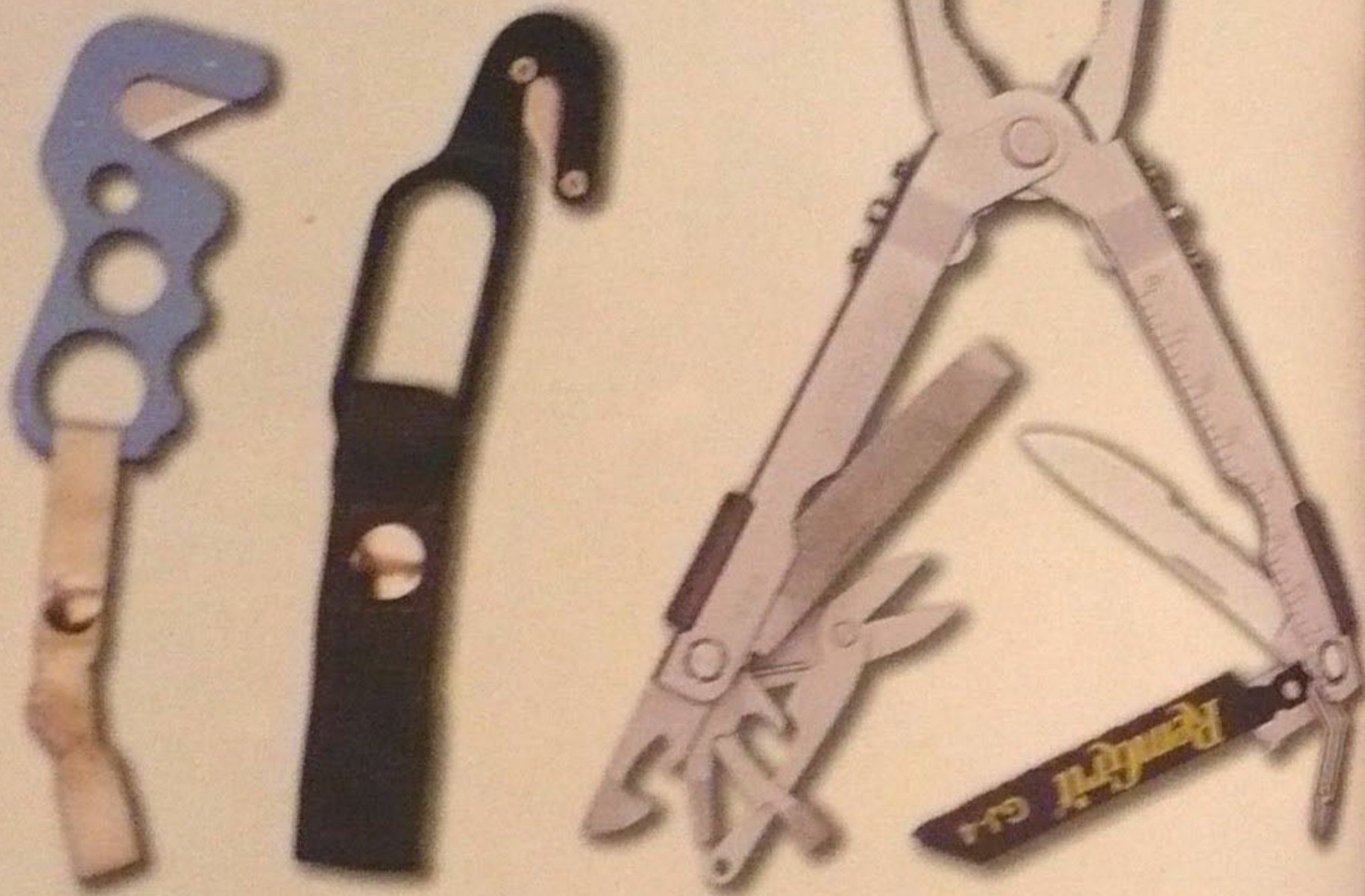
Вид модели парашютного ножа QSS 1 представляет собой компактные инструменты для безопасного разрезания ремней и строп. Многофункциональный инструмент Мультиплекс Делюкс (Multiplex Deluxe) фирмы «Гербер» получил исключительные свойства по укладке и ремонту парашюта (детали) 3-го специализированного.
