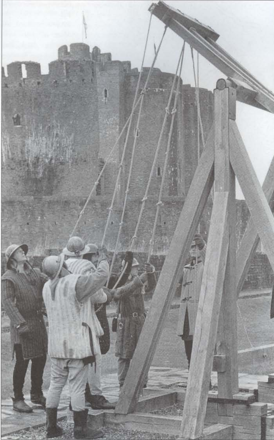
Реконструкция требюше в Керфилли. Хотя реконструировался европейский требюше, конструктивно он мало чем отличается от китайского и действовал на том же принципе.
