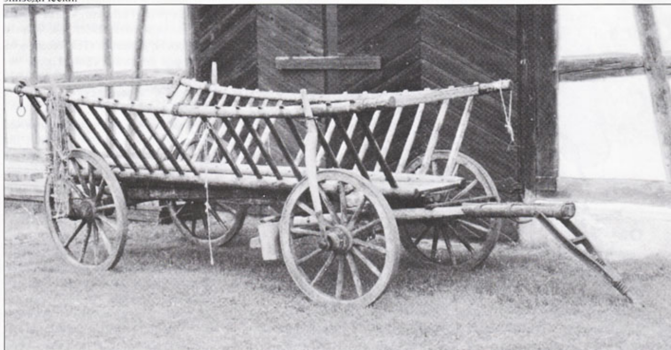
Телега из коллекции музея в Агорне, Германия, 1835 г. Во времена Крестьянской войны в Германии использовались точно такие же телеги. Обратите внимание на способ крепления колеса. На рисунках того времени видно, что устройство телеги могло быть весьма сложным, дополнительные изменения в конструкцию телеги вносились для того, чтобы приспособить ее к боевому применению. Если требовалось загрузить телегу, ей наращивали борта. Полная телега сверху закрывалась тентом и могла служить убежищем для солдат. Во время Гуситских войн телеги превращали в грозные боевые повозки с навесными бортовыми панелями с бойницами. Но нет свидетельств аналогичных переделок телег в ходе Крестьянской войны в Германии. Поэтому можно только спекулировать на тему боевой повозки германских крестьян.
