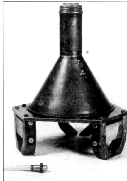
Германский 3-кгкумулятивный заряд Hafthohlladung, закрепленный на магнитном основании. Заряд устанавливался вручную на вражескую бронетехнику. На переднем плане лежит детонатор.
