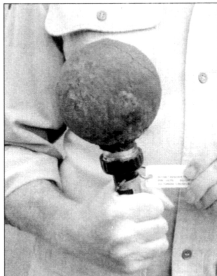
«Липучая бомба» - противотанковая граната № 74. В верху стеклянной сферы, в которой заключен взрывчатка, нанесен липкий состав.
