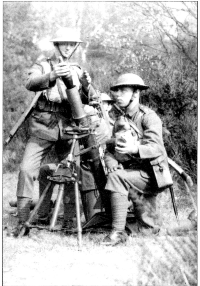
Снимок из учебного пособия британской армии. Фото выполнено до войны. Фотограф зафиксировал для истории расчет 3-дюймового миномета, штатное батальонное средство усиления. Боец справа держит в руке кожаный чехол с прицелом. Опытный расчет выпускал из миномета до десяти мин в минуту. Боевая масса миномета составляла 112 фунтов.
