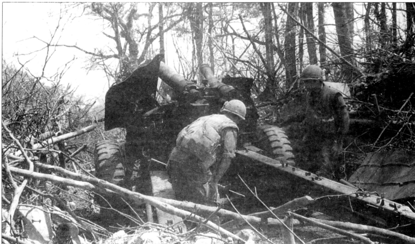
Морские пехотинцы осматривают трофей - 122-мм орудие. Орудия более крупных калибров северовьетнамцы не использовали. Орудие успел вывести из строя расчет - ствол разорван внутренним взрывом.
