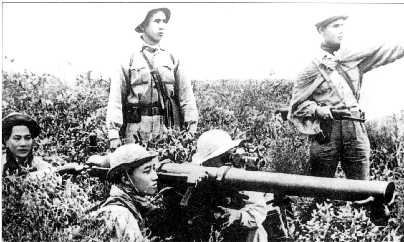
Северовьетнамцы отлично использовали имевшееся у них вооружение - пулеметы, минометы, безоткатные орудия. На снимке - 82-мм безоткатное орудие Б10. Личного имущества у солдат практически нет, даже каски есть не у всех.
