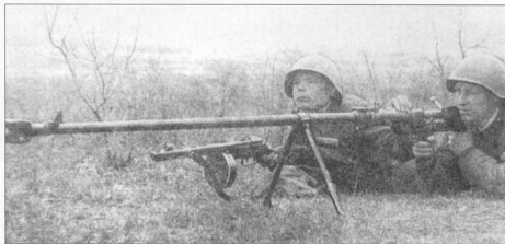
Советское 14,5-мм противотанковое ружье ПТРД-41 имело длину около двух метров, но весило при этом сравнительно немного — 17,44 кг. Казенная часть ствола отсоединяется от дула примерно в том месте, где лежит рука второго номера. На марше второй номер нес ствол, а первый номер — затвор.
