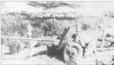
Советская 45-мм пушка образца 1942 года появилась на смену 45-мм пушке образца 1932 года, а также еще более старых 37-мм пушек. В конце 1943 года на смену этой пушке появилась 57-мм пушка ЗиС-2. Длинный ствол и наличие подкалиберного боеприпаса делали советскую сорокапятку довольно эффективной для своего калибра пушкой. Калибр 45 мм характерен только для советской артиллерии.
