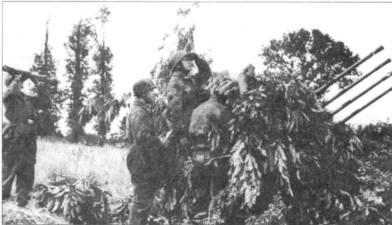
Расчет зенитного орудия 2 см Flakvierling-38, Западный фронт, лето 1944 г. Счетверенная зенитная установка обладала практической скорострельностью 880 выстрелов в минуту, 2 см Flakvierling-38 являлось одним из самых эффективных средств борьбы с низколетящими воздушными целями. В августе 1944 г. на вооружении люфтваффе имелось не менее 3605 таких зенитных установок. На снимке слева - парашютист измеряет расстояние до цели стереоскопическим дальномером Entfernungsmesser Im 36. На десантнике одет камуфлированный комбинезон позднего типа.
