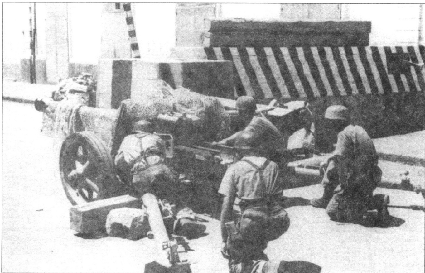
Расчет противотанкового орудия 7,5 см PaK-40 на улице Рима, конец мая 1944 г. Только по каскам без отбортовок можно определить принадлежность солдат к Fallschirmjäger. Обратите внимание на подложенные под колеса камни и деревянный брус, которые не давали пушке откатываться после выстрела.
