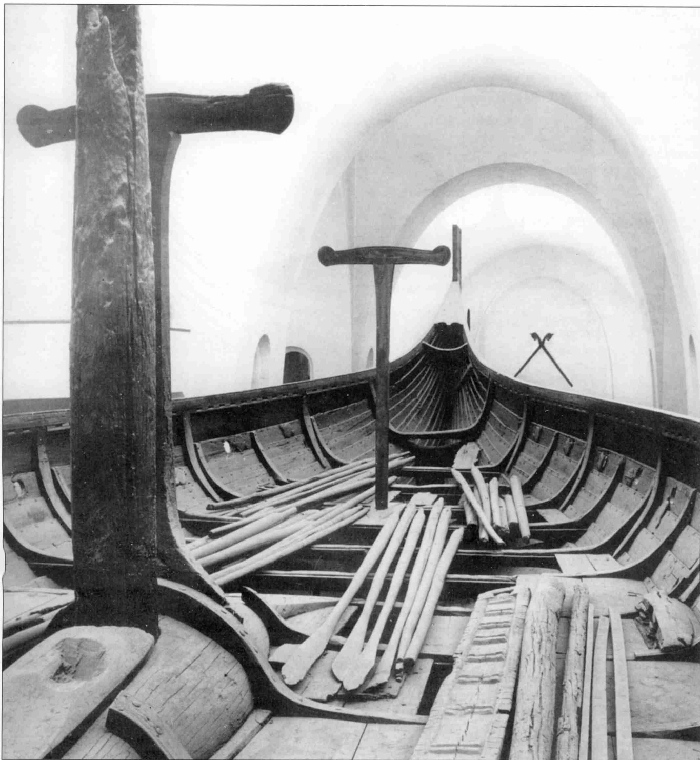
Интерьер ладьи из Гокстада. На переднем плане виден гигантский пяртнерс. Обратите внимание на мощные кривые кницы, соединяющиеся с бимсами. Отверстия для весел в борту снабжены заглушками. Верхние пояса обшивки крепятся на кницы. На бимсах вырезаны шпунты для укладки досок палубы. Справа от пяртнерса лежат весла, сходни, рангоут. У правого края фотографии виден чурбак (beiti-ass).
