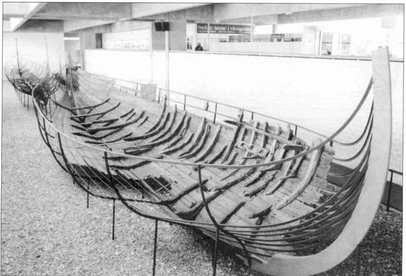
Остатки корабля Скулделев-1. На левой скуле заметен фрагмент стрингера, врезанного в шпангоуты, а чуть ниже чурбак (beiti-ass).
