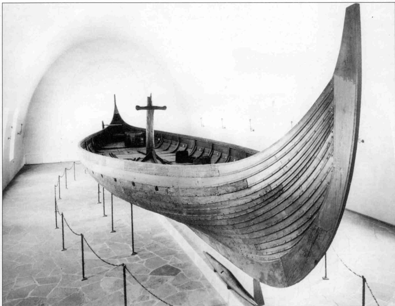
Шедевр скандинавского кораблестроения - ладья из Гокстада. Обратите внимание на вместительность корпуса, а также на стык между килем и форштевнем.
