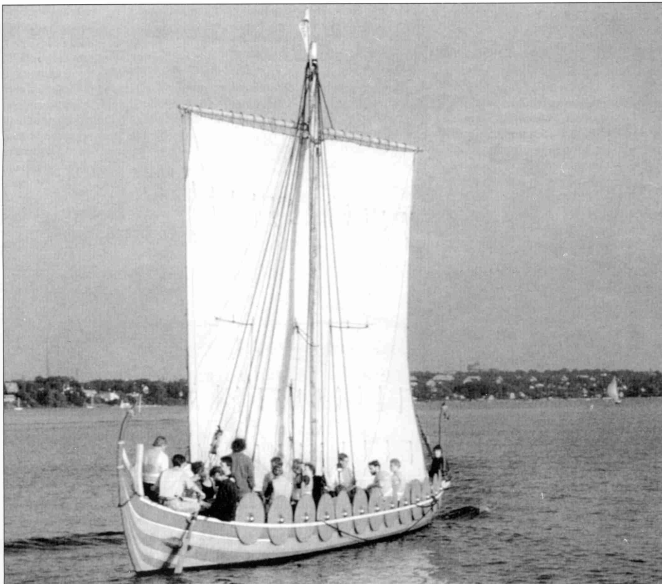
Реплика Скулделев-5 под названием «Хельге Аск» в водах Роскильде-фьорда. Пояса обшивки выкрашены в красный и желтый цвета, в соответствии с изображением на гобелене из Байё.
