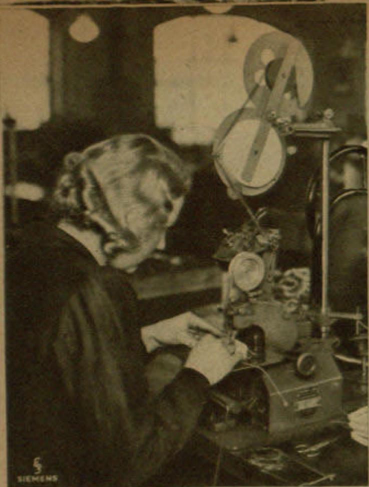
Mit der Bandagiermaschine werden die Ständerspulen eines Motors einbandigiert
