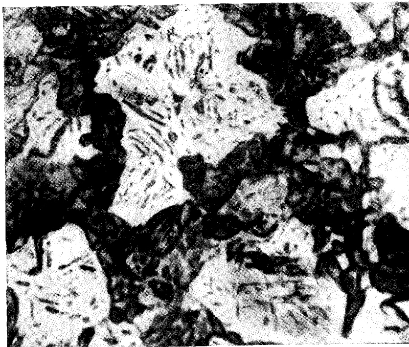
Рис. 150. Микроструктура при большом увеличении. 1 — нож, Глазов-4, мартенсит и троостит, ув. 600; 2 — долото, Кушманское-1, мартенсит и троостит, ув. 600
