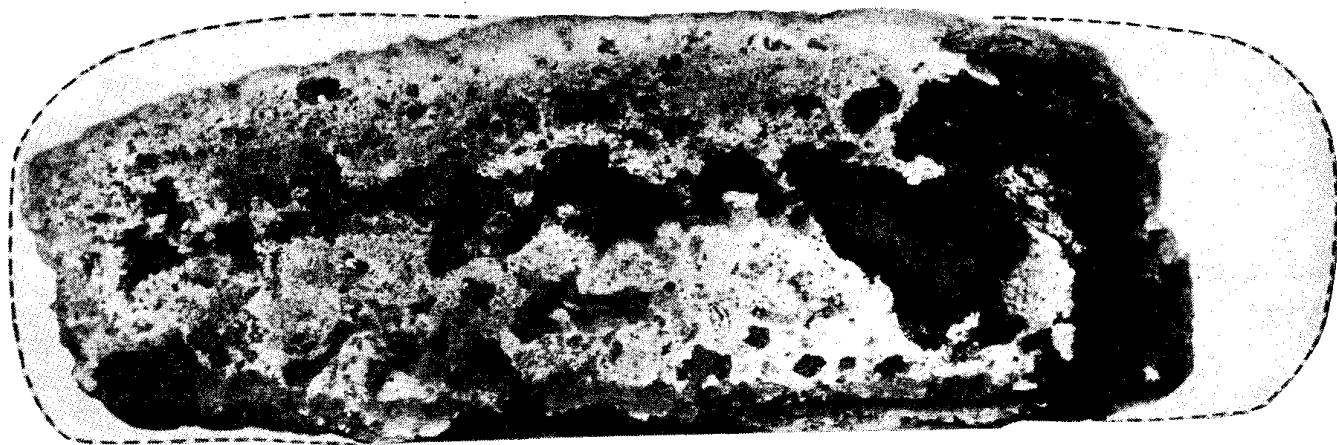
Рис. 14. Макроструктура крицы железа с Княжей Горы Белые поля — железо, темные поля — пустоты
