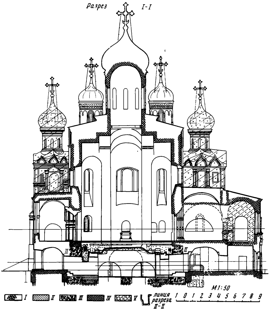
Рис. 4. Поперечный разрез Благовещенского собора (чертеж)
