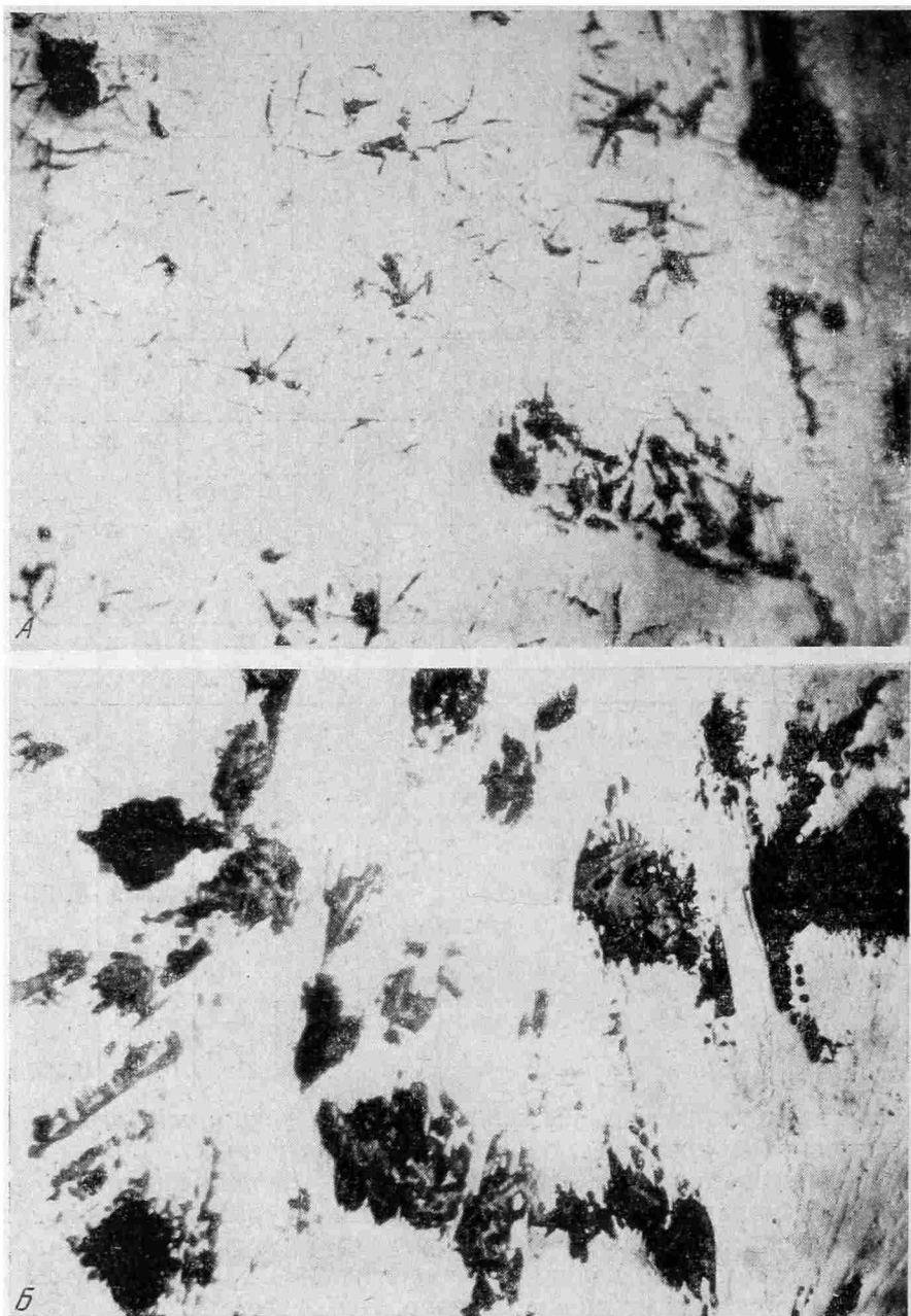
Рис. 3 а — микроструктура нетравленного фрагмента № 1; б — микроструктура нетравленного фрагмента № 2.
