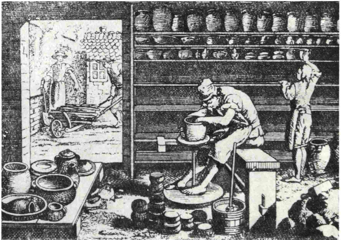
Рис. 5. Формовка на ножном круге. Германия, XVIII в. (А. Рит)
