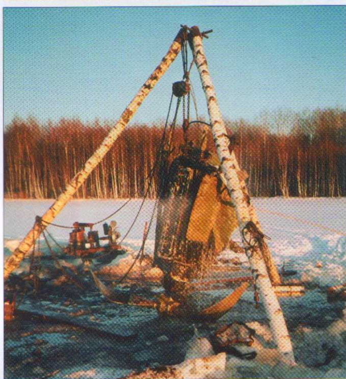
Подъем двигателя АМ-38, пролежавшего более 50 лет на дне лесного озера.
