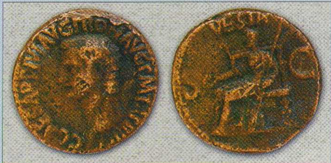
Поддельная монета императора Калигулы. На аверсе искусственные выбоины, имитирующие коррозионные каверны, волосы «залиты» металлом, вверху монеты — след от ступленного литника. На реверсе расплывчатые надпись «VESTA» и фигура.
