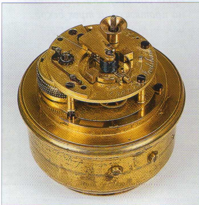
Механизм морского хронометра. Мастер Шарль Фродшам. Лондон. Середина XIX в.
