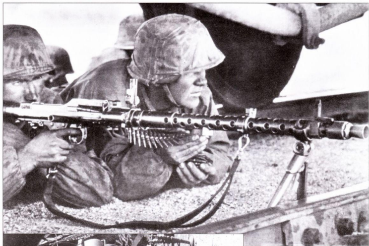
Постановочный снимок. Пулемет MG 34 на сошках от MG 13. Обратите внимание на неправильно вставленную пулеметную ленту, что однозначно изобличает постановочность фото.
