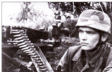
Пулемет MG 42 с металлическим желобком, делающим подачу ленты более мягкой.
