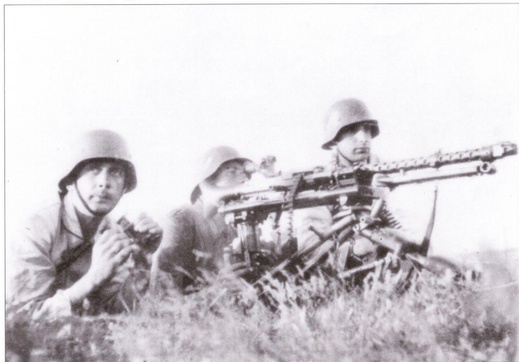
Пулемет MG 34, судя по кожанку ствола из ранней производственной серии. Пулемет установлен на станке с оптическим прицелом.
