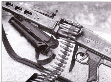
Левая сторона кожуха ствола пулемета MG 42. Видны пятна ржавчины, пробившейся через фосфатное покрытие. Для соединения деталей используется клепка, обжим и точечная сварка. Предохранитель в форме срезанного круга расположен в верхней части бакелитовой pistolетной рукоятки. Предохранитель находится в положении Feuer.
