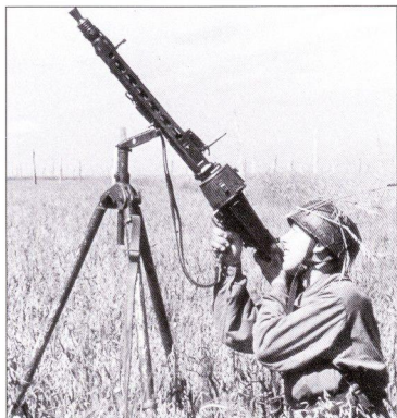
Пулемет MG 42 на облегченном трехногом станке Dreifuß 34 в зенитной конфигурации.
