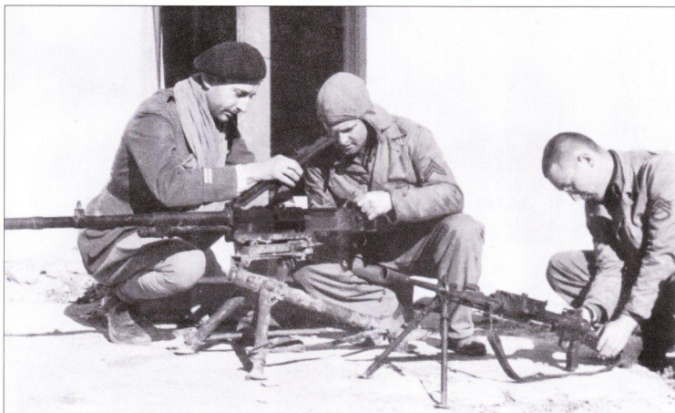
Американские солдаты осматривают итальянское трофейное оружие, захваченное на севере Италии. Справа 6,5-мм пулемет MG 099(i) Breda 1928, справа 8-мм пулемет MG 259(i) Breda 37.
