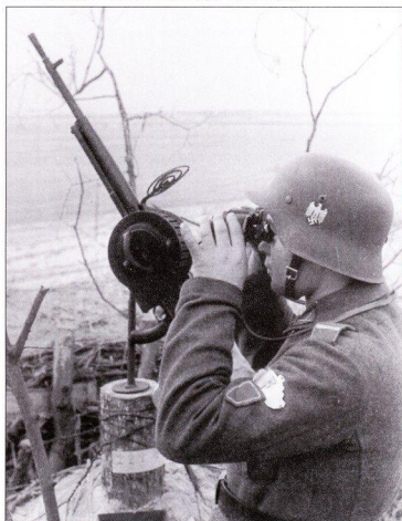
Пулемет MG 311(f) был разработан как танковый пулемет. Расположенный сбоку барабанный магазин вмещал 150 патронов.
