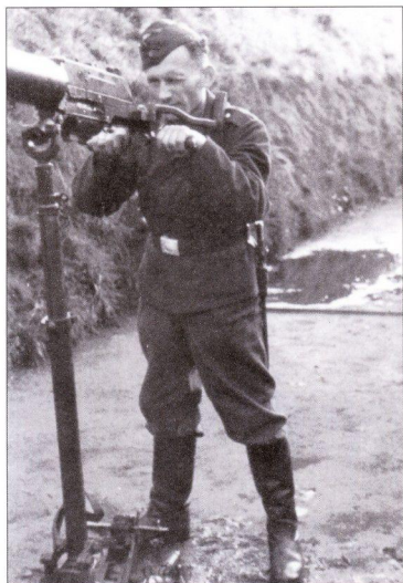
Пулемет Schwarzloze, приспособленный для стрельбы по воздушным целям. Обратите внимание на приклад, упрощающий наведение пулемета.
