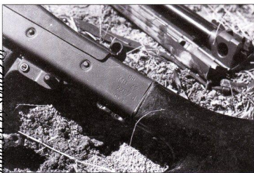
На стальной коробке нанесены метки MG 42/2257d/cga — название пулемета/серийный номер/код изготовителя (Maget, Берлин).
