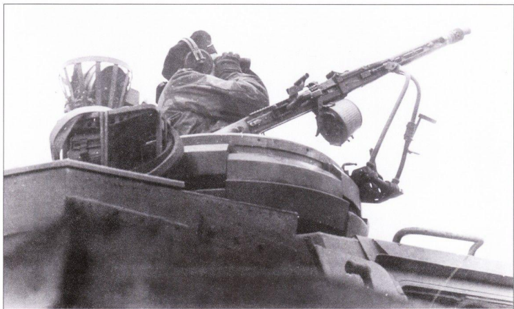
Редкий снимок, датированный 21 ноября 1943 г. Зенитный пулемет MG 42 на командирской башенке танка PzKpfw III. Обратите внимание переноску Gurttrommeltraeger, закрепленную на башне.
