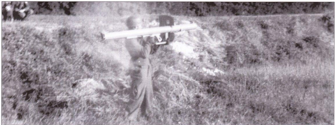
Выстрел. Трубу держуло вперед, но парашютист удержал ее и устоял на ногах. Благодаря тому, что труба высоко поднята над землей, пыль почти не поднялась. Ракетный двигатель оставлял сравнительно немного дыма.
