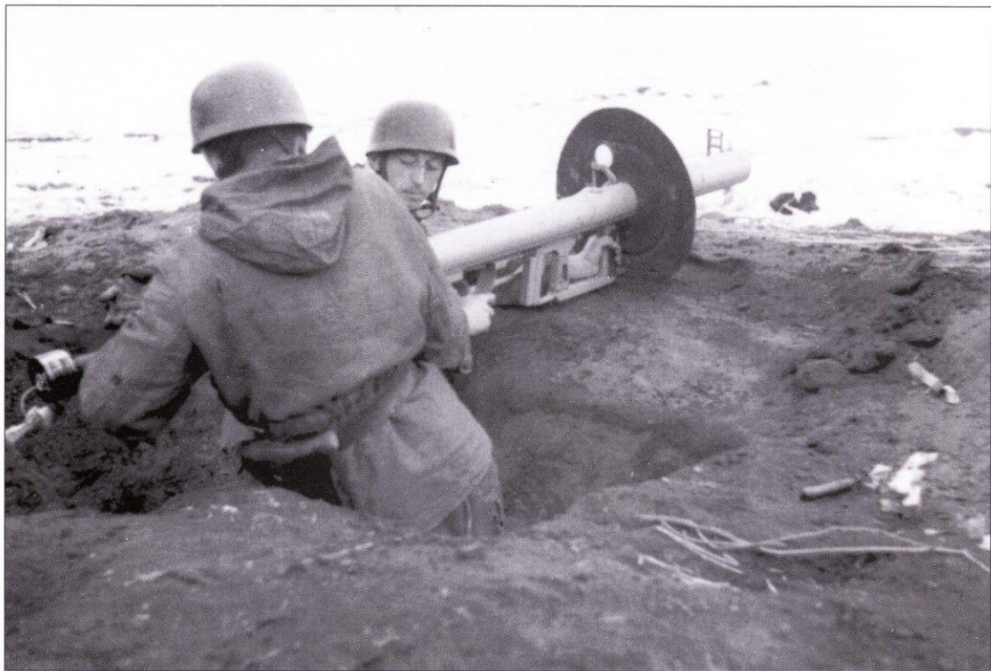
Два парашютиста готовятся стрелять из панцершрека с экспериментальным круглым щитом. Щит прикрывал стрелка от огненного хвоста ракеты. В конце 1943 – начале 1944 г. из боевых частей поступали неоднократно предложения дополнить трубу щитом, что заставило конструкторов заняться экспериментами. Италия, 1943 г.
