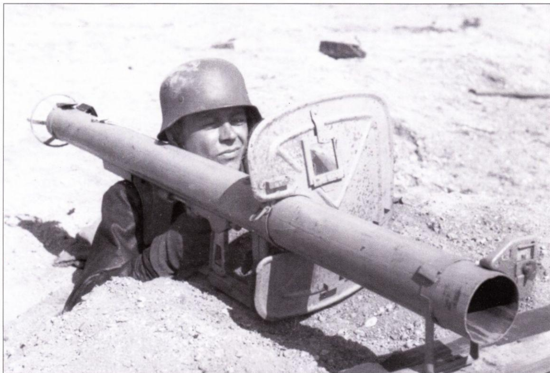
Демонстрация панциррека. Труба оснащена передним упором и регулируемым прицелом. Пятна на щитке, по-видимому, вызваны реактивной струей ракеты. Германия, 1944 г.
