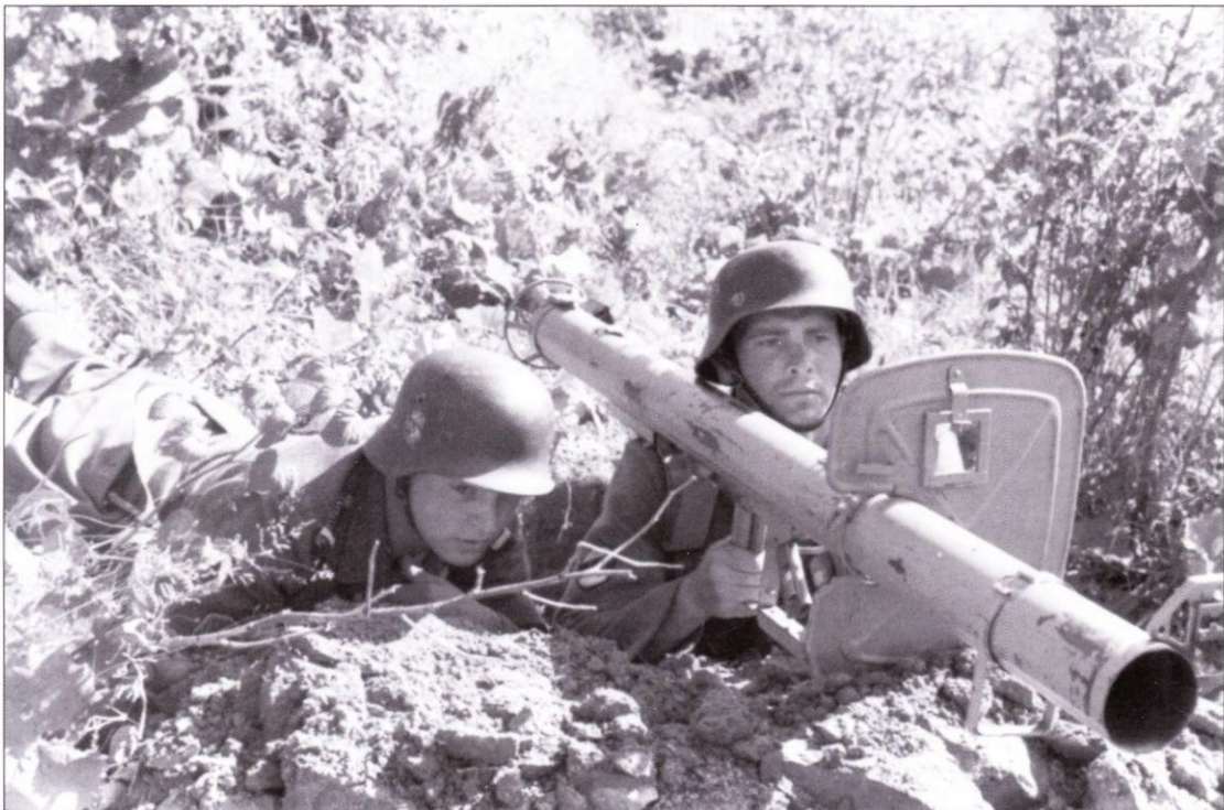
Вид спереди. Заметны некоторые изменения в конструкции панциррека, внесенные в феврале 1944 г. Труба получила упор в передней части, а также щиток. Регулируемый прицел отсутствует. Россия, август-сентябрь 1944 г.
