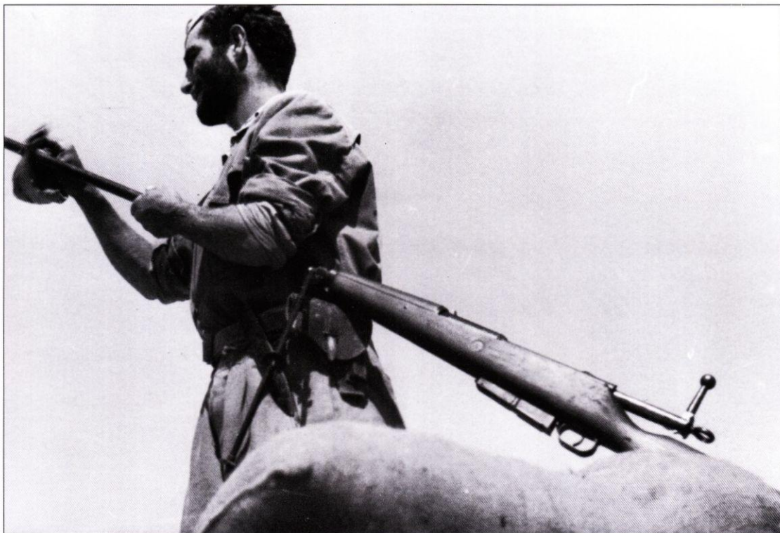
Итальянский солдат чистит польское противотанковое ружье. Хорошо видны открытый цилиндрический затвор и четырехзарядный магазин. Для самозащиты итальянец вооружен пистолетом «беретта», который он носит в кобуре на пояском ремне. Северная Африка, начало 1942 г.
