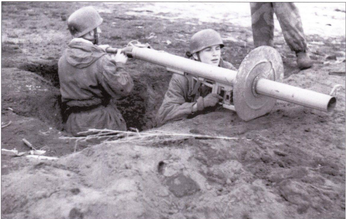
Тот же панцершрек, вид спереди. Хотя на первый взгляд кажется, что щит сделан из крышки мусорного ведра, более пристальное изучение обнаруживает довольно сложную конструкцию. Обратите внимание на небольшое круглое окошко, через которое стрелок наводит трубу. Официально трубу дополнили щитком в феврале 1944 г. В серию пошел щиток прямоугольной формы, имевший другую конструкцию.
