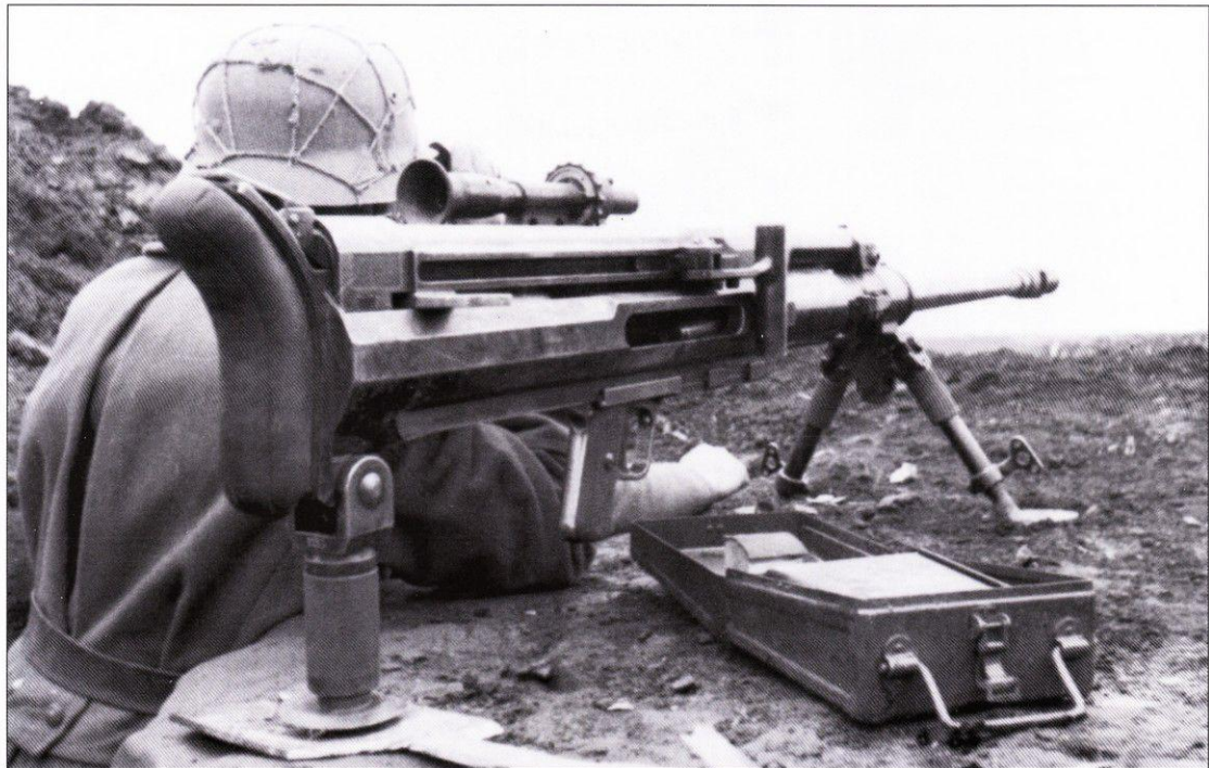
Немецкий солдат рядом с весьма эффектно выглядящим противотанковым ружьем Solothurn. Данное ружье стреляло патронами 20x105. Ружье взведено, сквозь окно эжектора виден верхний патрон в магазине. Верхняя поверхность замка не видна, поэтому мы не можем сказать, это трофейный образец, или закупленный немецким правительством. Юг России, 1941 г.
