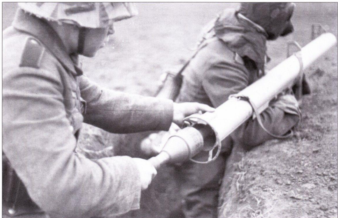
Заряжающий вставляет ракету в трубу, удерживая пружинный зажим. После того, как ракета вставлена в трубу, зажим отпустился и удерживал ракету в трубе.
