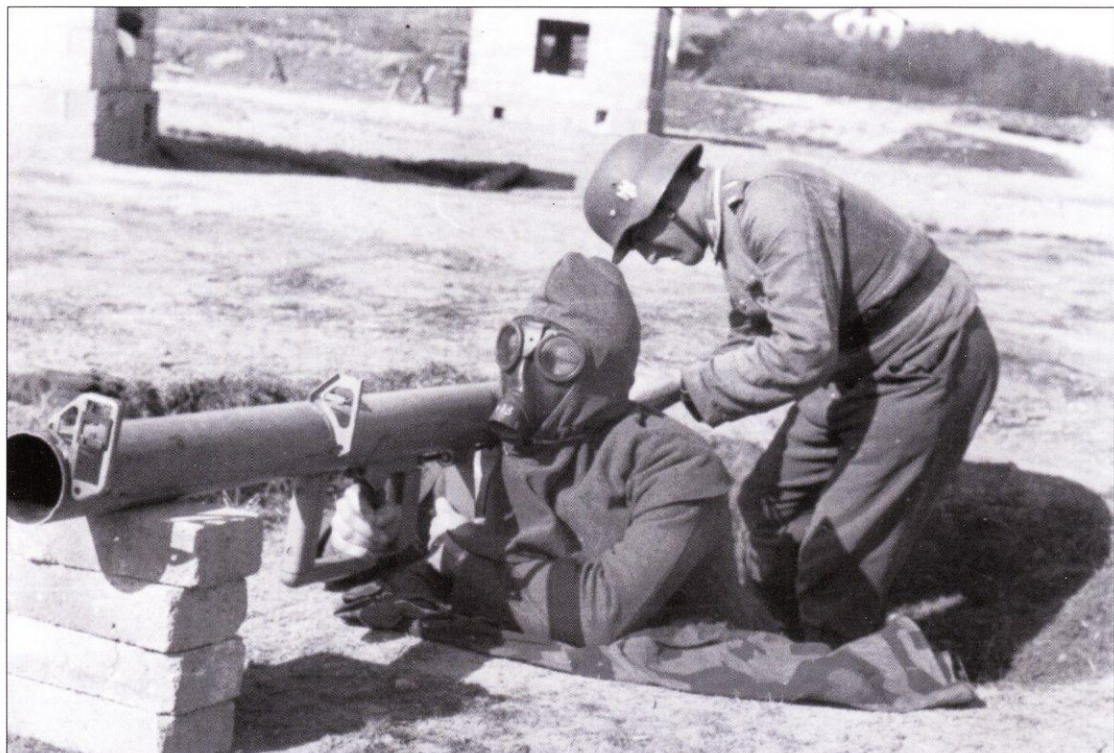
Два следующих снимка показывают демонстрацию раннего панциршрека. У трубы отсутствует щиток, поэтому стрелку для защиты лица приходится носить противогаз без фильтра. Отсутствует и передний упор, поэтому стрелку пришлось положить передний конец трубы на четыре кирпича. Заряжающий вставляет в трубу ракету. Франция, 1944 г.
