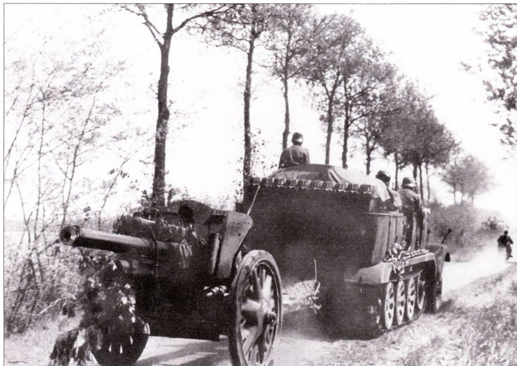
Полугусеничный тягач Sd.Kfz. 6 с орудием 10,5 см I.FH18 на прицепе. Данная гаубица являлась штатным орудием дивизионной артиллерии как в вермахте, так и войсках СС.
