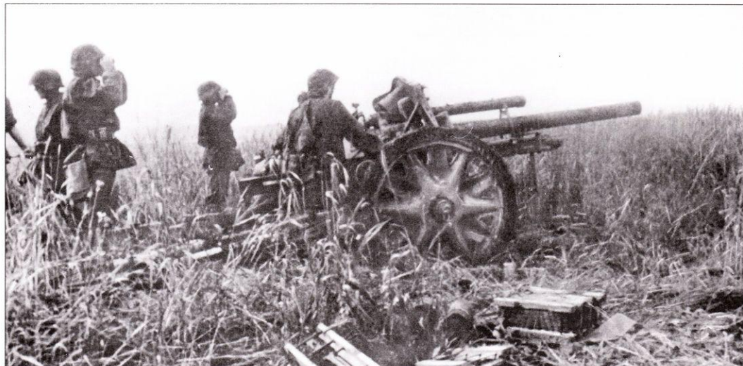
Легкая полевая гаубица 10.5 см 1.FH18 артиллерийского подразделения СС на огневой позиции, Восточный фронт. На переднем плане - тара от снарядов и зарядов. Все артиллеристы одеты в камуфлированные куртки, что вообще сильно странно - артиллеристы почти никогда не носили камуфляж, который в первую голову предназначался для пехоты.
