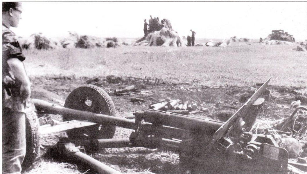
Солдат ваффен СС осматривает советскую 76,2-мм противотанковую пушку ЗиС-3, сокрушенную германским танком. ЗиС-3 являлась основным оружием советской дивизионной артиллерии и часто использовалась для борьбы с бронетехникой. На заднем плане - счетверенная зенитка 2 см Flakvierling-38 на огневой позиции. Счетверенные 20-мм пушки с большим эффектом использовались также для поражения наземных целей.
