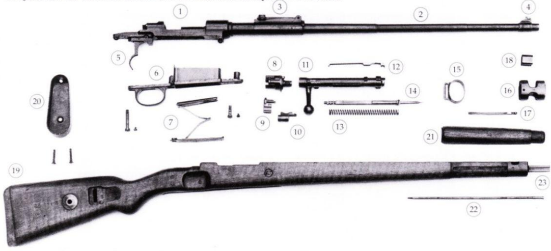
Винтовка Kar 98k в разрезе: 1. Ствольная коробка. 2. Ствол. 3. Целик. 4. Мушка. 5. Спусковой крючок. 6. Магазин и предохранительная скоба спускового крючка. 7. Пружина магазина и подаватель. 8. Муфта затвора. 9. Предохранитель. 10. Курок. 11. Затвор. 12. Экстрактор. 13. Боевая пружина. 14. Боек. 15. Заднее кольцо. 16. Переднее кольцо. 17. Пружина. 18. Намушник. 19. Пятак приклада. 20. Ствольная накладка. 22. Шомпол. 23. Крепление штыка.
