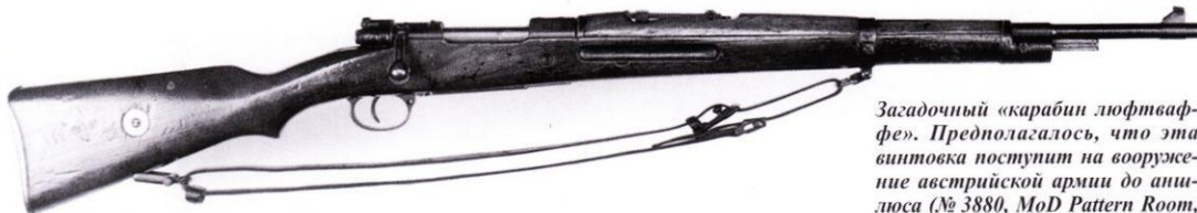
Винтовка G98/40, переделанная из венгерской винтовки Manlicher Model 35. Обратите внимание на германский способ соединения плечевого ремня и крепление под штык (№ 3714, WTS Koblenz).
