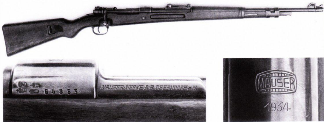
«Стандартная модель II» была непосредственной предшественницей Kar 98k. Кроме выемок на ствольной накладке винтовка также характеризовалась отсутствием люверса на прикладе и отсутствием фиксатора затвора. В остальном она полностью идентична Kar 98k в том виде, в каком он начал выпускаться в 1934 г. на заводе Sauer & Sohn. Данный образец помечен клеймом DRP на левой стороне приклада (№ 65863, H.I. Visser).
