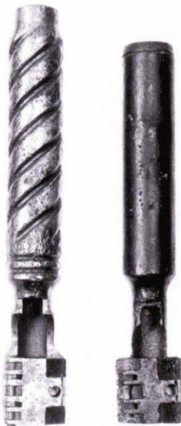
Два типа глушителя для Kar 98k. Слева глушитель длиной 25,5 см и меткой «286». Справа глушитель длиной 23 см, видимые клейма отсутствуют (WTS Koblenz).
