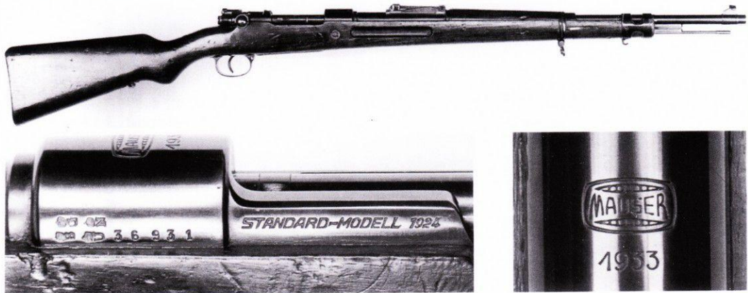
«Стандартная модель I» появилась в середине 20-х гг. После сравнительных испытаний с укороченной Kar 98b, ее оснастили затвором с изогнутой рукояткой (№ 36931, WTS Koblenz).
