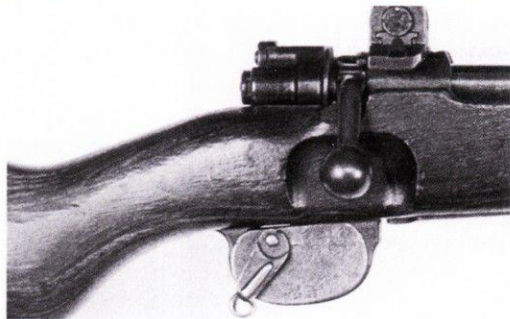
Зимний спусковой крючок для снайпера в варежках. Спуск производится с помощью внешнего рычага (MoD Pattern Room Nottingham).
