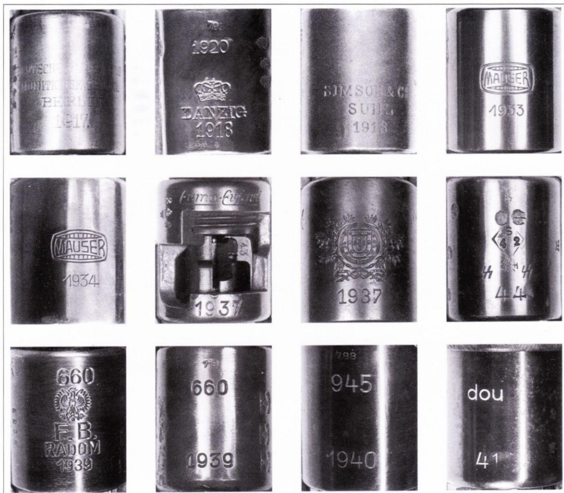
Различные клейма на ствольной коробке. Верхний ряд, слева направо: Gewehr 98, переделанная в Kar 98k, Karabiner 98 (1920 означает, что карабин попал в арсенал рейхсвера), Gewehr 98, Standard Modell I. Средний ряд: Standard Model II, Kar 98k с разрезанной ствольной коробкой, португальский Kar 98k, подделка SS-Kar 98k. Нижний ряд: бывшая польская G 29/40, Luftwaffe-karabiner, G33/40, G24(t).
