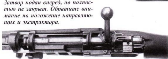
Затвор повернут и заперт. Шептало в зацеплении с курком отведены назад. Запирающие упоры полностью вошли в свои гнезда. Обратите внимание на боек и взведенную пружину.
