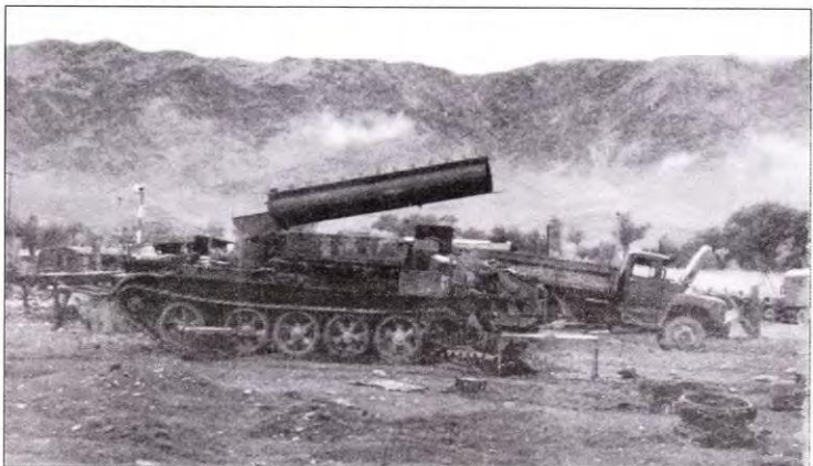
БРЭМ Т-54Т, захваченная душманами в Самаркеле в 1979 г. Трубы аппаратуры подводного вождения частично поднята.
