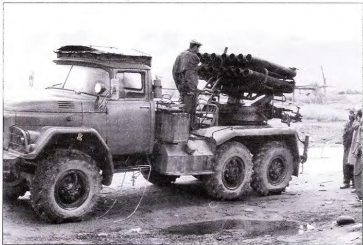
16-зарядная установка реактивной залповой системы калибра 140 мм БМ-14. Эту лишённую опознавательных знаков машину душманы захватили в Самаркеле в 1989 г. БМ-14 встречались в Афганистане нечасто.
