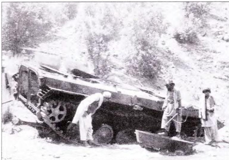
Эта БМП-1 получила прямое попадание гранатой РПГ-7 или подорвалась на mine, внутренним взрывом с машины сброшена башня. Машина камуфлирована краской каменисто-серого цвета поверх штатной зеленой окраски.
