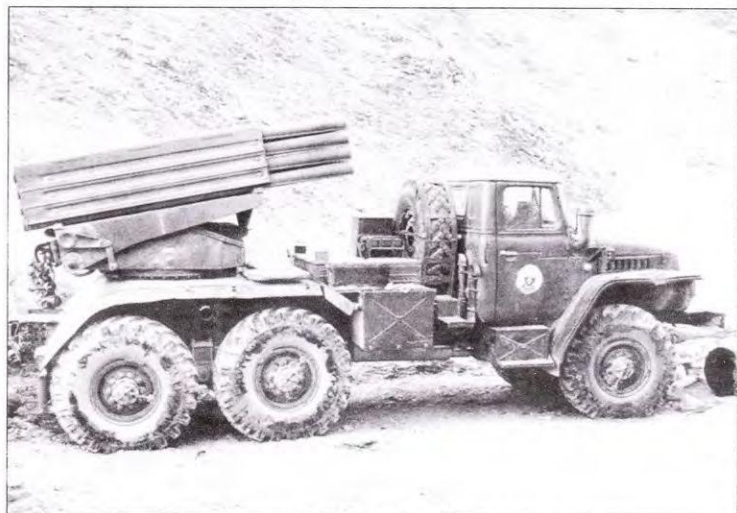
122-мм боевая машина БМ-21 афганской армии. Оознавательный знак характерен для заключительного периода войны.
