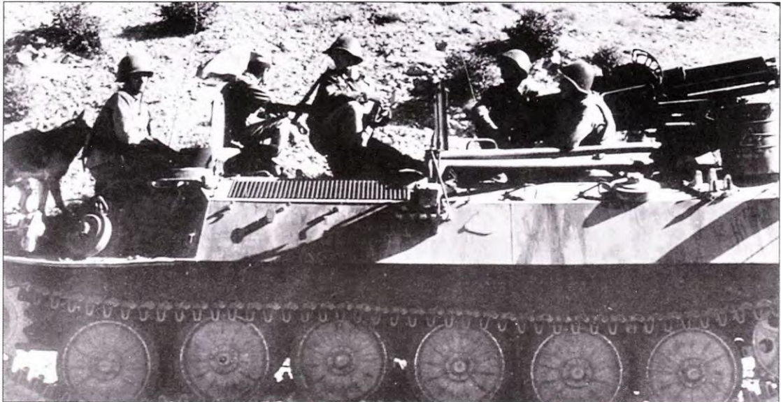
Бронетранспортер МТ-ЛБ сфотографирован на перевале Саланг летом 1988 г. Бронетранспортер вооружен автоматическим гранатометом «Василек» калибра 82 мм. На лобовую деталь бронетранспортера взобралась немецкая овчарка, натасканная на поиск мин. Там же, в передней части, видна противотанковая мина ТМ-62.
