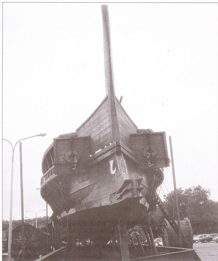
Нос «Олимпиады». Хорошо виден окованный бронзой таран - основное оружие атакующей триремы, с помощью которого утверждалось греческое господство на море. Перед самым ударом в вражеский корабль гребцам приказывали табанить весла, чтобы избежать слишком глубокого проникновения тарана в корпус вражеского судна.
