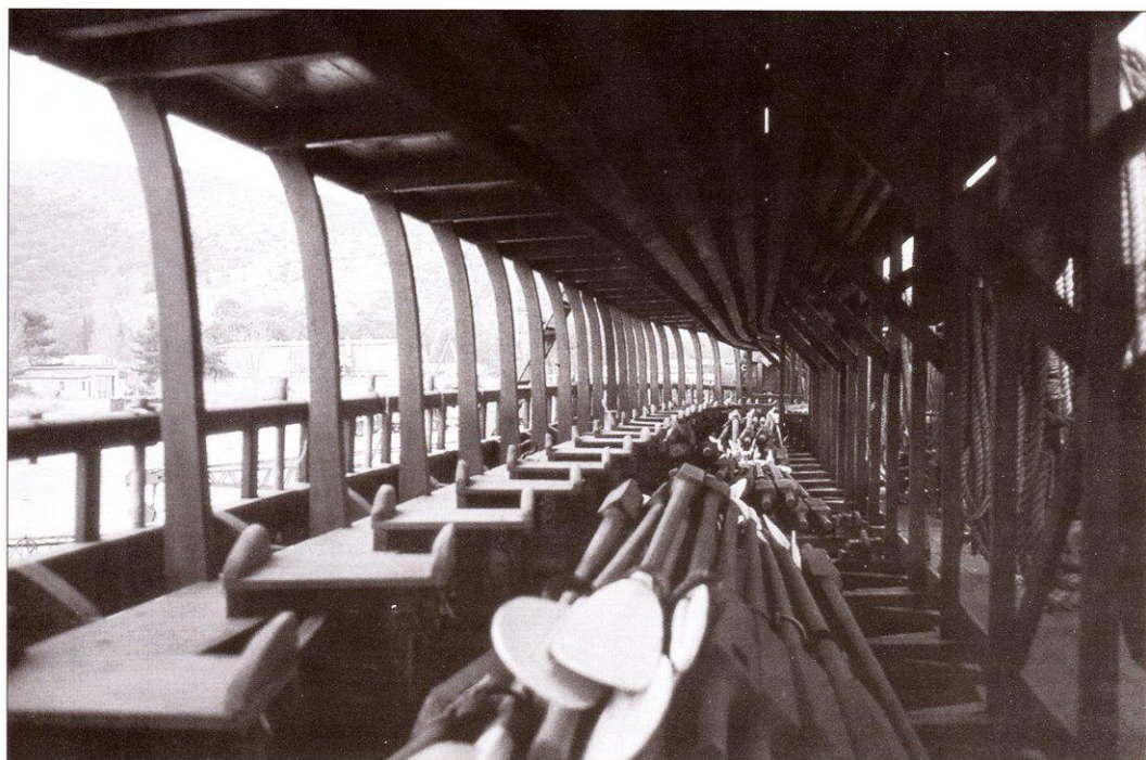
«Олимпиада», полномасштабная реконструкция афинской триремы, хорошо иллюстрирующая пространство нижней палубы и скамьи гребцов. Несмотря на то, что гребцы могли свободно дышать и имели вроде бы широкие проветривания в бортах, чтобы покинуть судно, в случае аварии или атаки противника это было самым опасным местом на корабле.
