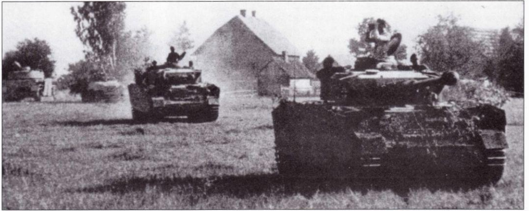
Два танка Pz.Krfw. IV Ausf.H на марше по открытой местности, на заднем плане - полугусеничный бронетранспортер Sd.Kfz. 251 Ausf. C. Справа - командирский танк Pz.Bef.Wg. IV Ausf. H. Антенна радиостанции Fu-8 установлена в специальном гнезде по правому борту корпуса.
