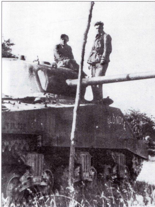
Подбитый 7 июня 1944 г. танками Pz.Krfw. IV из 12-го танкового полка СС танк «Шерман - Фарфлай» Mk Vc из эскадрона «В» 27-го канадского танкового полка. Вооруженный британской 17-фунтовой противотанковой пушкой «Шерман - Фарфлай» являлся наиболее сильно вооруженным танком союзников на момент вторжения в Нормандию.
