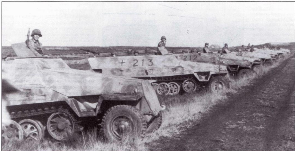
Линейка полугусеничных бронетранспортеров Sd.Kfz. 251/1 Ausf. D из 3-го батальона 26-го панцергренадерского полка. Машины выстроили в ряд перед инспекцией полка генерал-фельдмаршалом фон Рунштедтом. Все бронетранспортеры выкрашены в темно-желтый цвет и камуфлированы пятнами зеленого и красно-коричневого цвета. Цифры трехзначных бортовых номеров написаны краской черного цвета.
