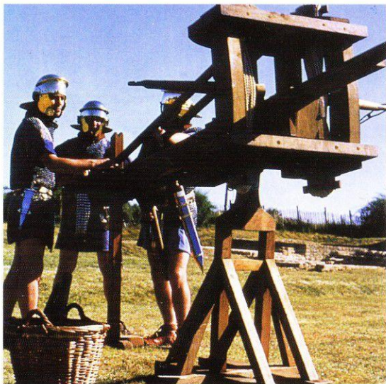
Малая баллиста из Legio XX Valeria Victrix, экипировка легионеров соответствует периоду Флавиев. Установка сделана по описаниям Ветрувия - специалиста по артиллерии, жившего в I веке до н.э.
