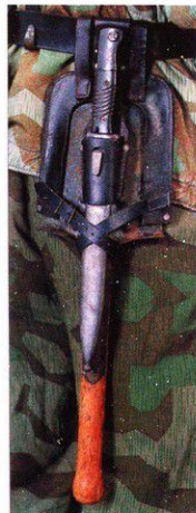
Разные ракурсы складной лопаты и способ её ношения. В собранном виде штык лопаты фиксируется специальной сайкой. Штык этой лопаты может фиксироваться под прямым углом и использоваться как топыга.
