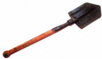
Разные ракурсы складной лопаты и способ её ношения. В собранном виде штык лопаты фиксируется специальной сайкой. Штык этой лопаты может фиксироваться под прямым углом и использоваться как топыга.
