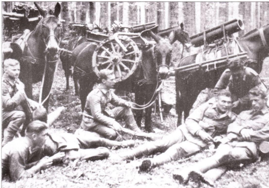
Отряд горной артиллерии со 150-мм пушкой L 15 чешского производства. Пушку перевозили в разобранном состоянии на семи вьючных животных.
