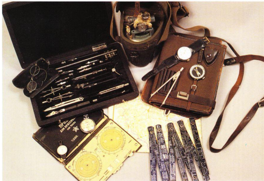
Инструменты артиллерийского или саперного офицера: готовальня, большой артиллерийский компас, планшетка с циркулем-измерителем, часами и наручным компасом, советская военная топографическая карта Венгрии, складной метр, секундомер, курвиметр, артиллерийский вычислитель.
