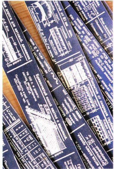
Складной офицерский метр образца 1941 г. Метр проградирован в метрической и футовой системах, а на линейках нанесены ценные инструкции и полезные сведения вроде ширины железнодорожной колеи, толщины брони германских танков, калибры советских и германских пушек и минометов, сведения по устройству полевой фортификации и т.д.
