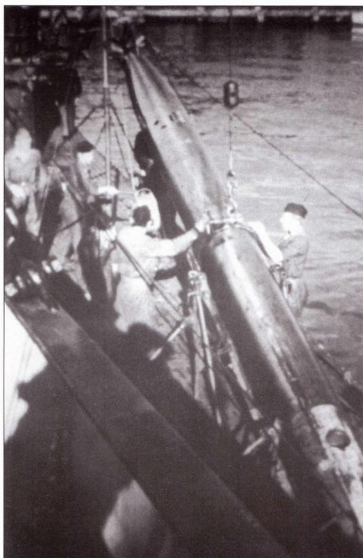
Погрузка торпеды на лодку VII серии. Погрузка торпед представляла собой сложный и трудоемкий процесс, требующий особой тщательности. Две торпеды из боекомплекта на лодках VII серии хранились в пространстве между прочным и легким корпусами.
