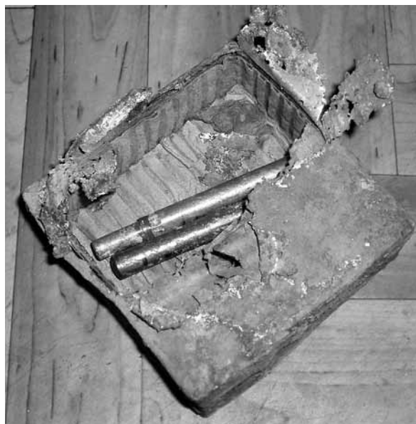
Рис. 4. Запалы в специальной укупорке
