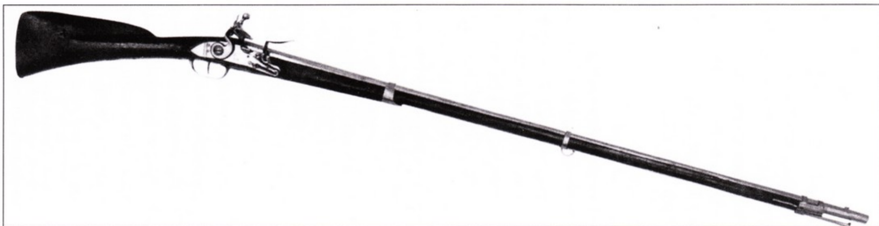
Армейский мушкет образца 1728 г. В 1741 г. деревянный шомпол заменили металлическим.
