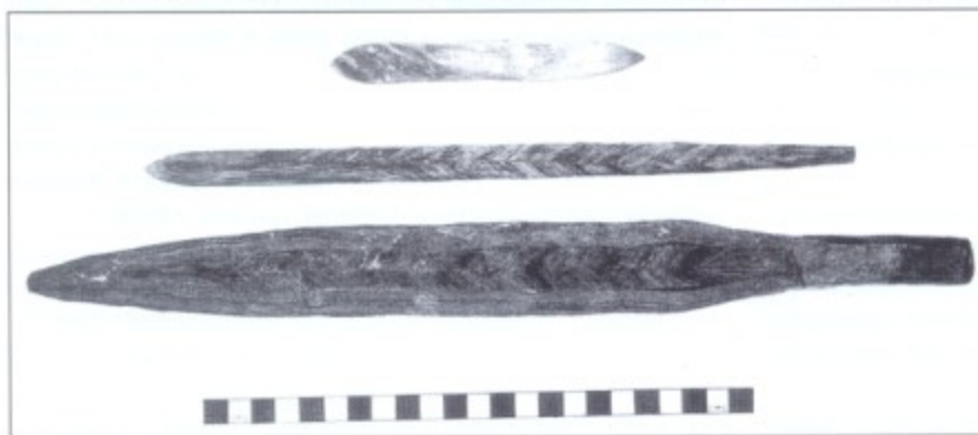
Современная реконструкция средневекового методаковки. Здесь показано несколько этапов изготовления оружия. На верхнем рисунке изображена сердцевина будущего лезвия. Чуть ниже можно видеть сердцевину, сплетенную с другими железными брусками. На третьем сверху рисунке показаны края закаленных стальных брусков, приваренных к сердечнику.
