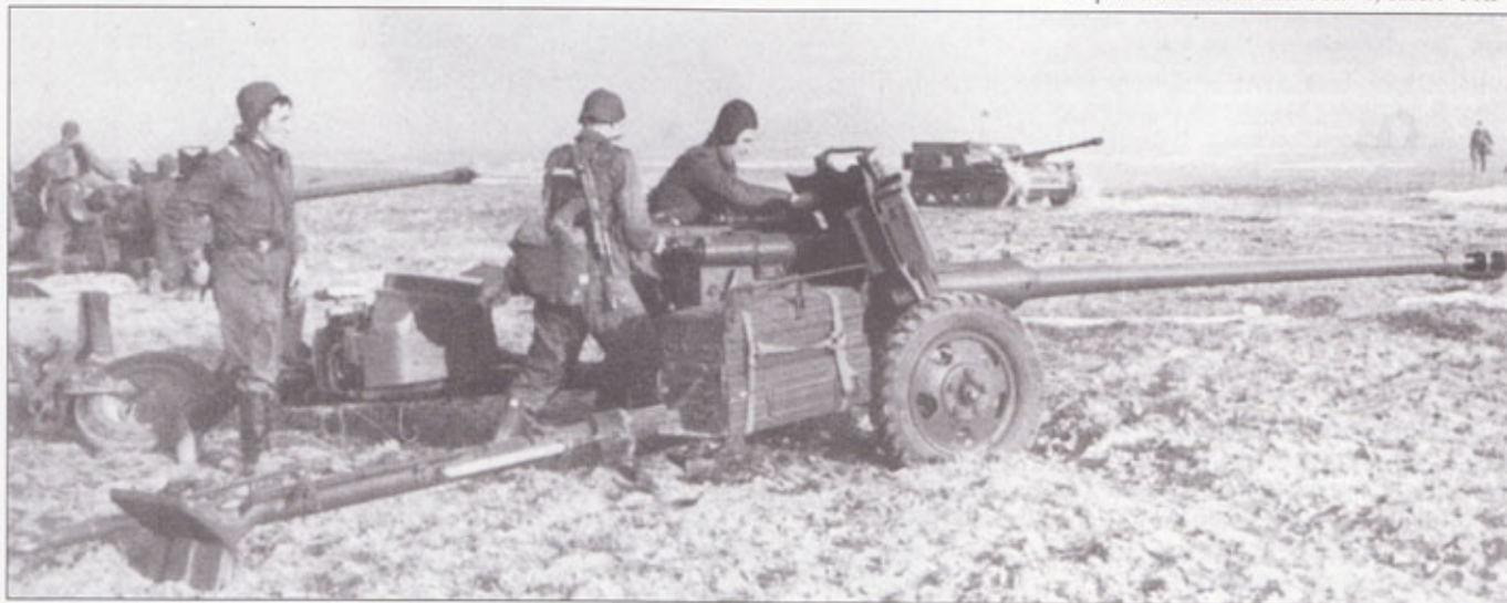
Противотанковая пушка СД-44 калибра 85 мм была разработана в 1944 г. В десантных частях использовались модернизированные варианты данного орудия, оснащенные двигателем. Благодаря двигателю отпадала нужда в тягачах, но скорость движения пушек на собственной тяге была очень небольшой. На заднем плане - самоходно-артиллерийская установка АСУ-57.
