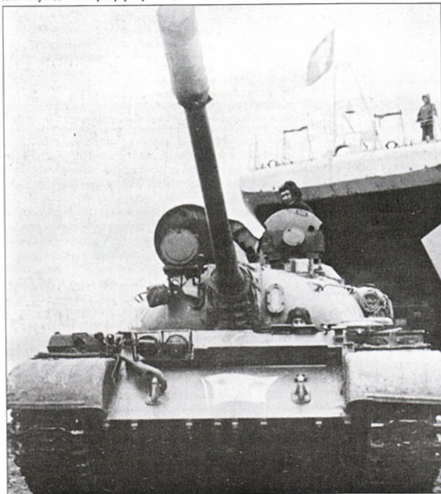
Высадка танка Т-55 с десантного корабля через носовую аппарель. В танковом батальоне морской пехоты из десяти танков Т-55, три обычно были огнеметные ОТ-55.
