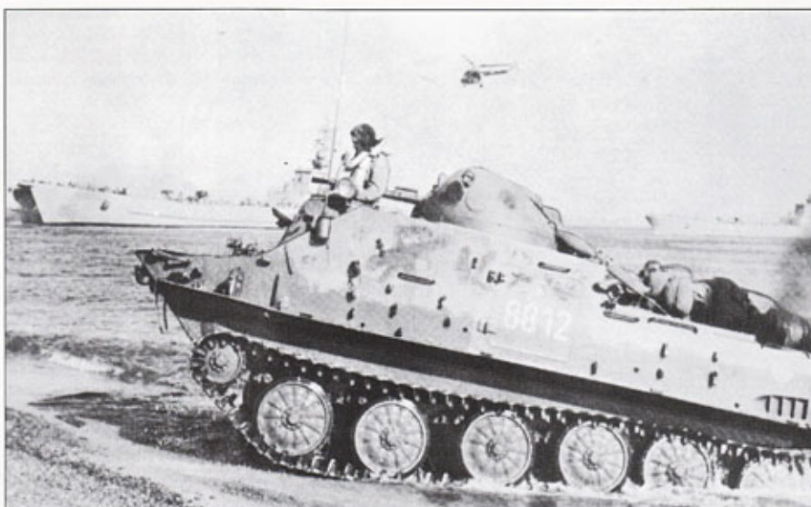
Основным типом бронетехники, состоявшей на вооружении 7-й Луцкой дивизии морской пехоты являлись плавающие гусеничные бронетранспортеры OT-64 NJPAS, вариант советского БТР-50, разработанный совместно в Польше и Чехословакии. На снимке - стандартная польская модификация TOPAZ-2AP с новой башней. Выше решетки водомета на борту БТР изображена эмблема дивизии (различима с большим трудом).
