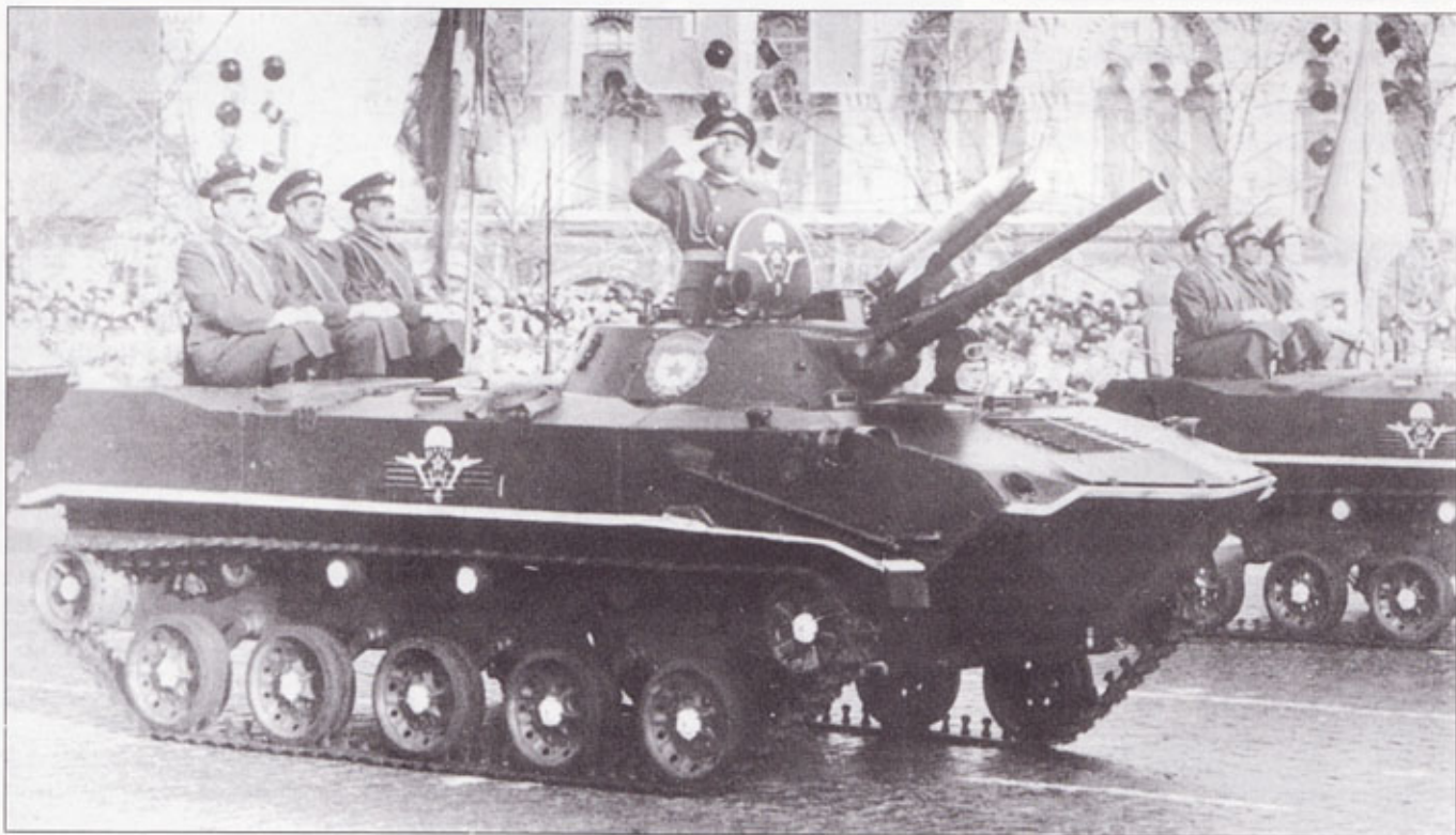
МД-1 с катками нового типа, машина позднего выпуска. Изменена форма решетки на верхней лобовой детали корпуса.
