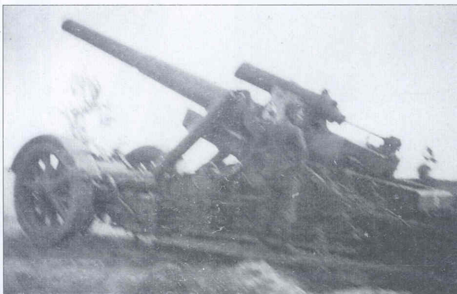
Орудие 15 см Канопе-39 поддерживает огнем атаку германской пехоты. Эта тяжелая пушка была создана инженерами фирмы Круп по заказу Турции, но с началом войны орудия оказались востребованными в вермахте. Подвижность тяжелых пушек сильно ограничивали обратительные дороги России.
