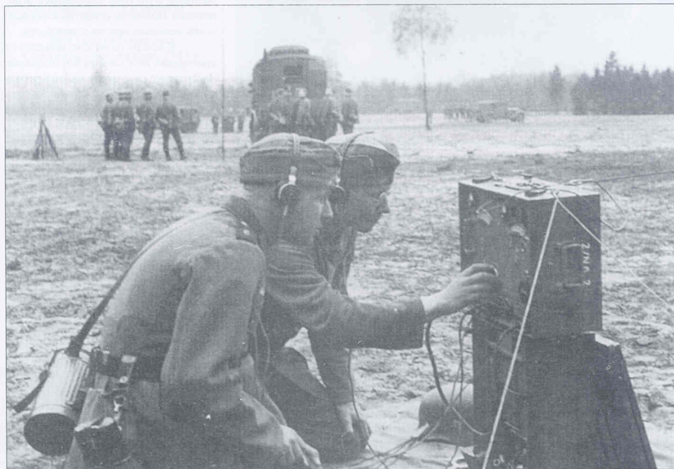
Радисты за работой. Остановка на марше. Радиостанция T-FuG массой 20 кг использовались в артиллерийских частях.
