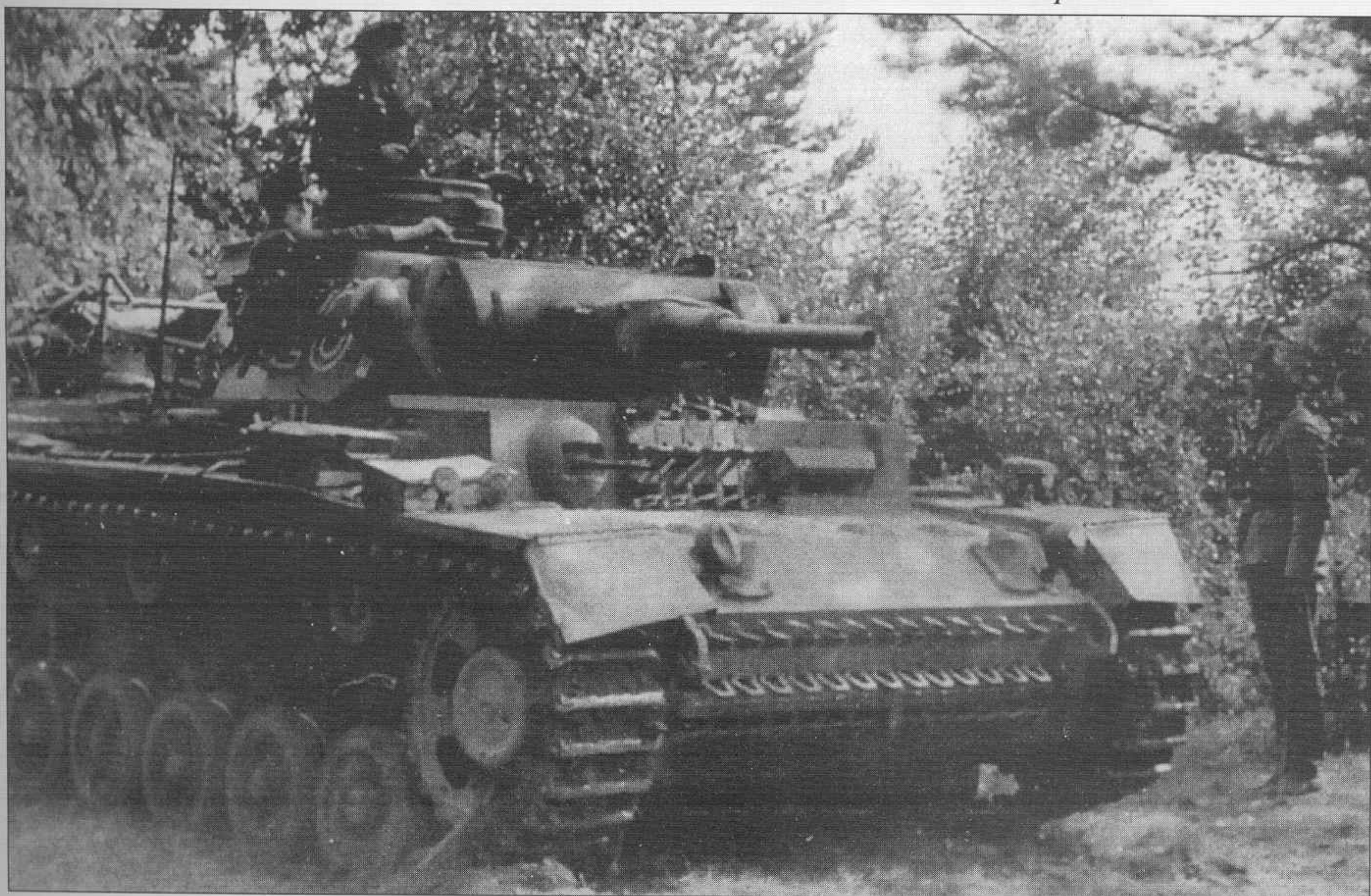
PzKpfw III, Восточный фронт, 1941 г. Танк вооружен 50-мм пушкой с коротким стволом, малоэффективной в борьбе с советскими средними и тяжелыми танками.
