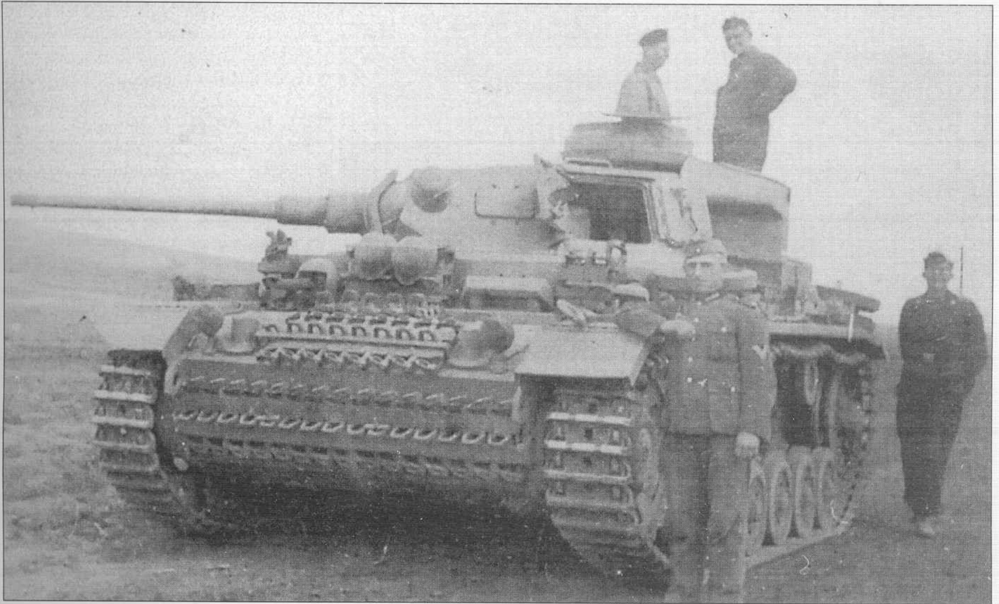
PzKpfw III, Восточный фронт, 1943 год. Запасные гусеничные траки развешены на лобовой броне в надежде усилить бронезащиту танка. Каски членов экипажа развешены снаружи.
