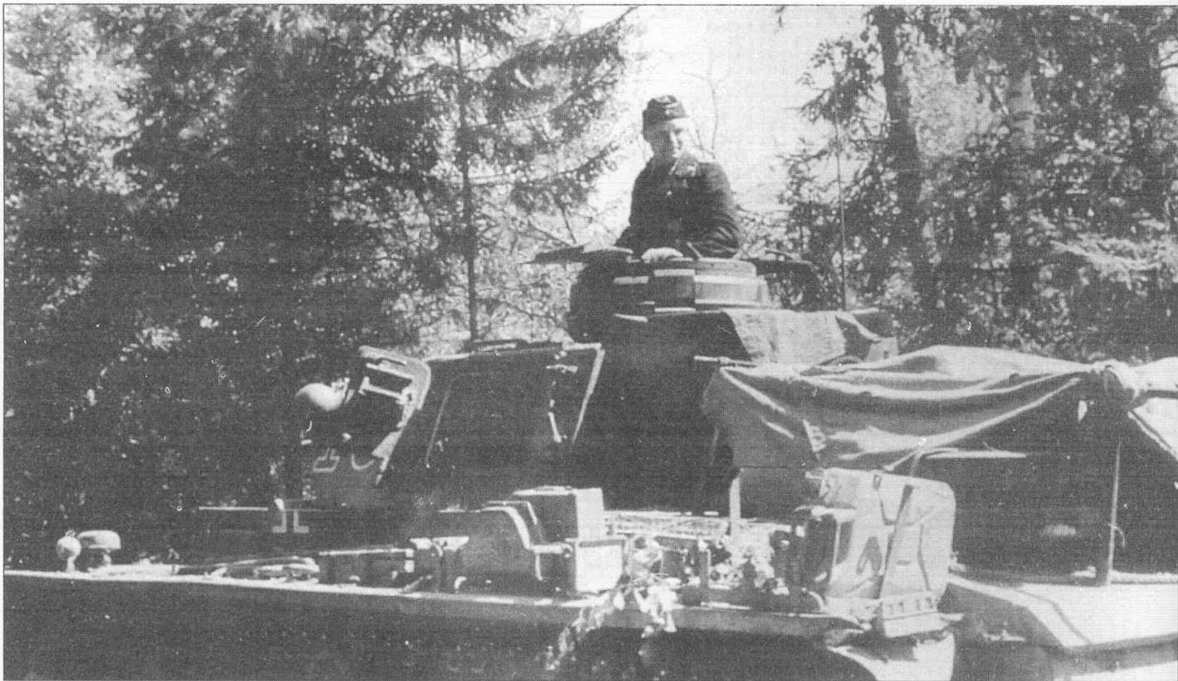
PzKpfw III на Восточном фронте. Как это было принято, снаружи танк обвешен запасными канистрами, ящиками с боекомплектom, касками и другими личными вещами экипажа.
