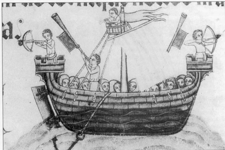
Это изображение военного корабля, заполненного бойцами в кольчужных хауберках, с устроенными в оконечностях кастелями, в которых располагались стрелки, лучники и арбалетчики, взято из английского манускрипта, написанного приблизительно в 1340 году. Luttrell Psalter, Британская библиотека, Лондон.
