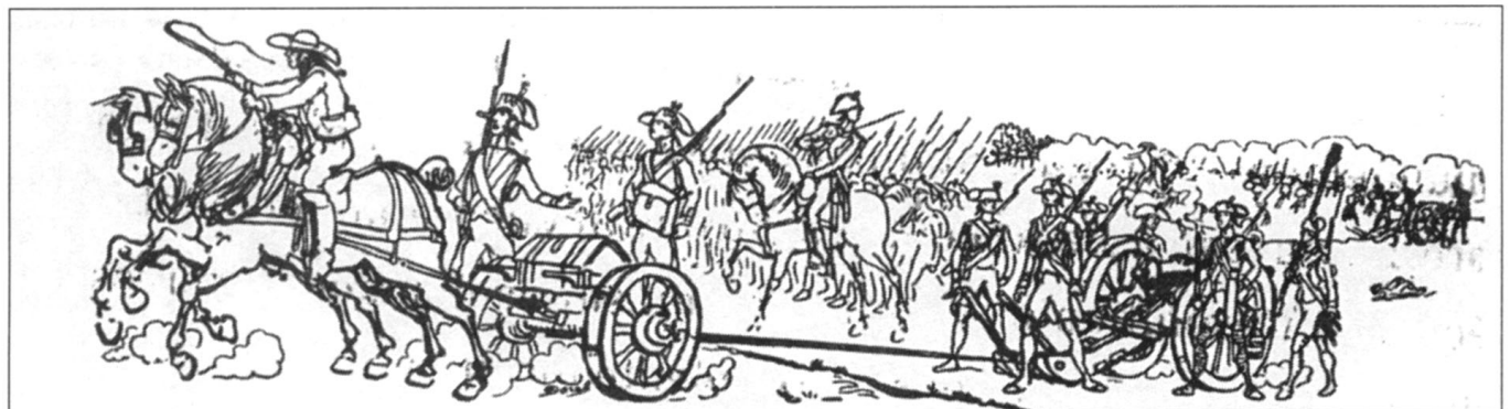
Полевая пушка, перемещаемая на новую позицию при помощи отвоза, закрепленного на орудийном передке, 1790-е гг.
