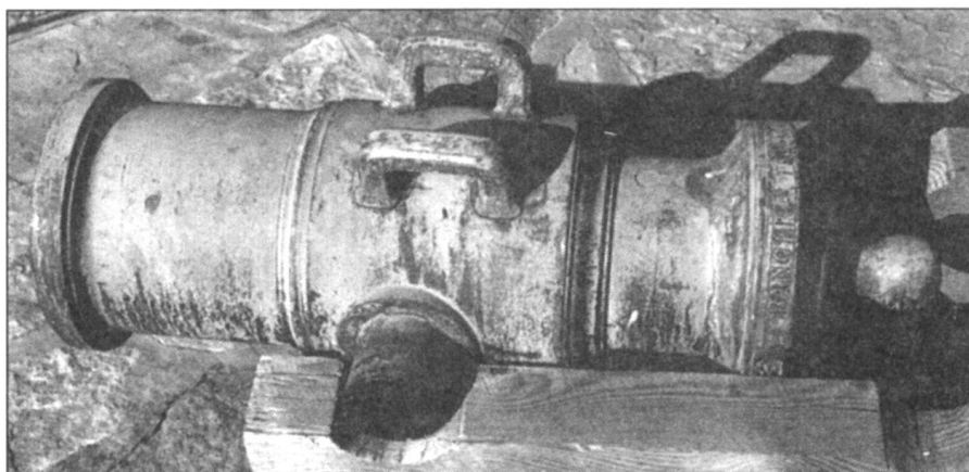
6-дюймовая бронзовая гаубица системы Грибоваля, отлитая Беранже в Дуэ 22 мая 1779 г. и несущая клеймо «27». (Форт Тикондерога, США).
