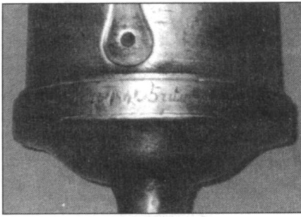
Деталь казенной части ствола легкой 3-фунтовой бронзовой полевой пушки, отлитого Рамю в Ле Крезе в 1794 г. По кольцу выгравирована надпись «Ratus au Creusot Brumaire L'An 3» (Рамю из Крезе, брюмер 3-го года).
