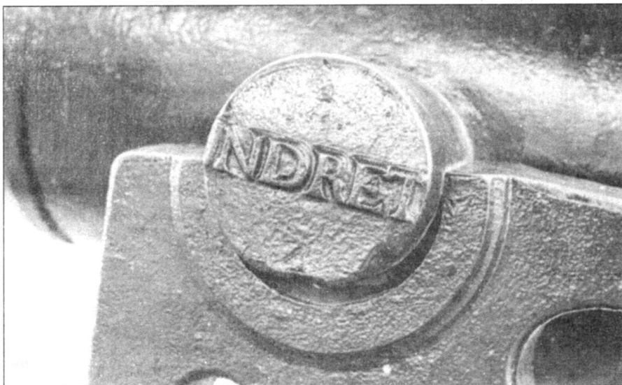
Клеймо «INDRET» на левой цапфе 18-фунтовой железной морской пушки модели 1778 г., отлитой в 1785 г. Согласно инструкциям, изданным в 1767 г., именно на этой цапфе должны были находиться инициалы мастера-литейщика. На литейном заводе в Инд्रे первые орудия были отлиты в 1778 г. В 1781 г. он стал королевским (или правительственным) предприятием и оставался важным производителем орудий в течение всей наполеоновской эпохи.
