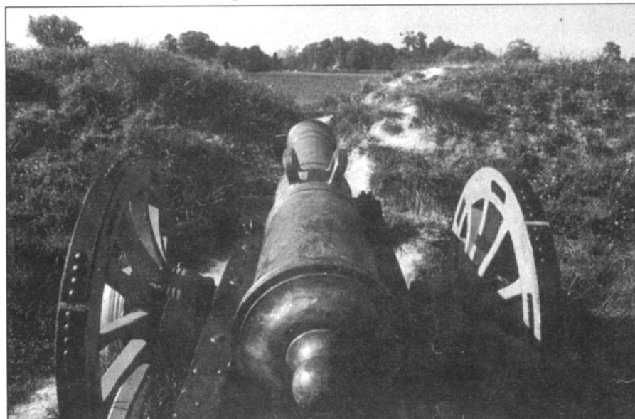
Осадная 24-фунтовая пушка системы Грибовала, 1770-е годы. Вид с тыльной стороны. Обратите внимание, что сверху тяжелого орудия этой системы видны прямоугольные скобы [handles], характерные для пушек полевой артиллерии, хотя на первоначальных чертёжах проекта на верхней части бронзовых стволов показаны более причудливо выглядящие «дельфины». Эта точная копия находится в Йорктауне, штат Вирджиния.
